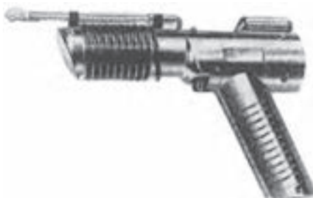
شکل ۹-۵- نشت یاب الکترونیکی تفنگی
