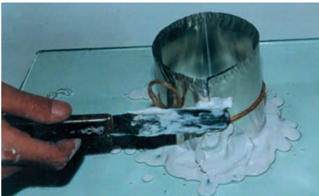
تصویر ۳- ساخت قالب کلی به شکل استوانه و بستن درزهای آن با خمیر گچ
