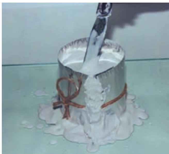
تصویر ۵- ج - خارج ساختن حبابهای هوا از دوغاب گچ
