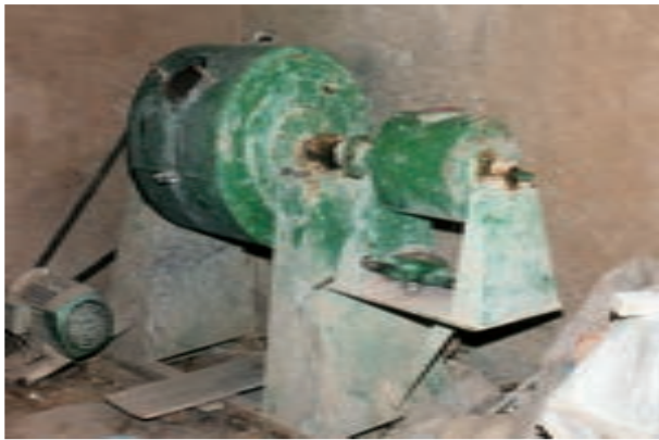
تصویر ۳- ب - آسیاب گلوله‌ای (بالمیل)
