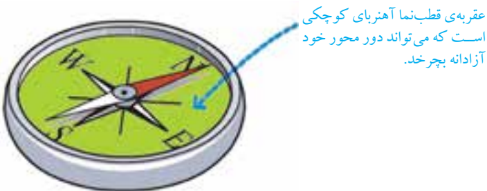
شکل ۴-۴ قطب‌نما را عقربه‌ی مغناطیسی نیز می‌نامند.
