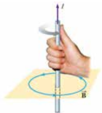
شکل ۴-۱۵ استفاده از قاعده‌ی دست راست برای تعیین جهت \vec{B} در اطراف یک سیم بلند و مستقیم حامل جریان
