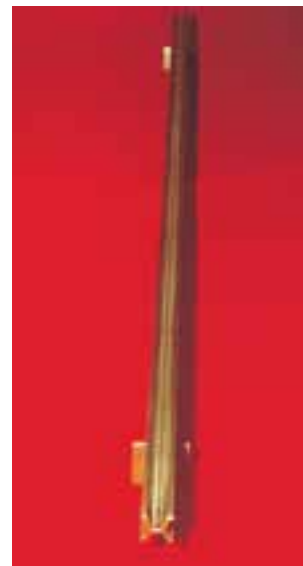
شکل ۱-۴ میله‌ی استاندارد طول از جنس پلاتین- ایریدیوم که در موزه‌ای نزدیک پاریس نگهداری می‌شود.
