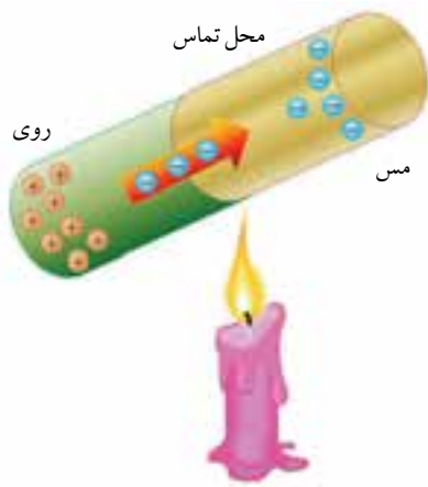
شکل ۲-۴۴ گرما سبب اختلاف پتانسیل دو سر تماس رساناها شده و در نتیجه الکترون‌ها از یک رسانا به رسانای دیگر شارش می‌کنند.
