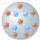
(ث) پس از دور کردن میله‌ی باردار، چون کره رسانای خوبی است همه‌ی بارها روی سطح آن پخش می‌شوند.
