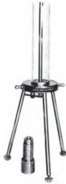
شکل ۲۴-۲- دستگاه سنجش ویسکوزیته (ویسل، زیومتر لوری)
