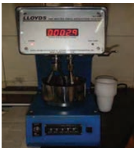
شکل ۲۸-۲ دستگاه بالانس آب با همزن ۱۸-۱۵ دور
