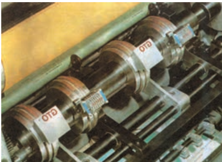
شکل ۴۳-۴- چاپ عادی + چاپ اضافی با کلیشه + شماره‌زنی + پرفراژ + خط‌زنی در یک مرحله
