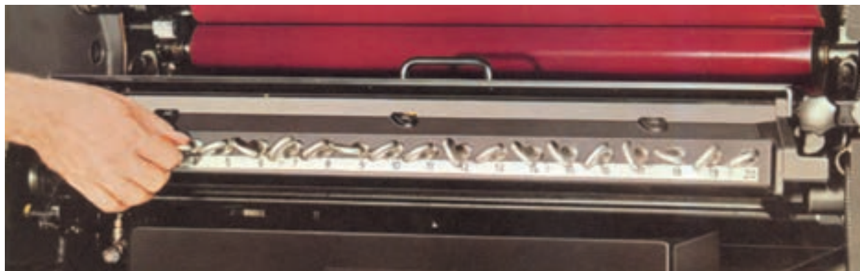
شکل ۱۱-۴- پیچ‌های تنظیم مرکب‌دان باید به آرامی و با دقت میزان شوند.
