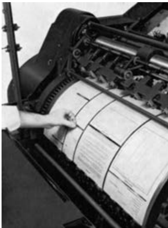
شکل ۴۲-۴- پرفراژ طولی و عرضی در یک مرحله
