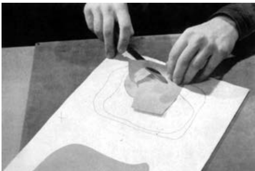
شکل ۲۴-۴- بریدن تکه‌ها جهت زیرسازی با چاقوی کاغذبری
