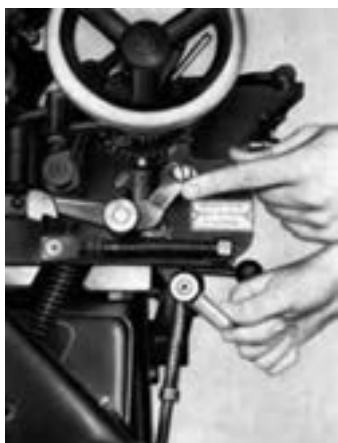
شکل ۴-۷- وصل کردن سیستم مرکب‌دهی
