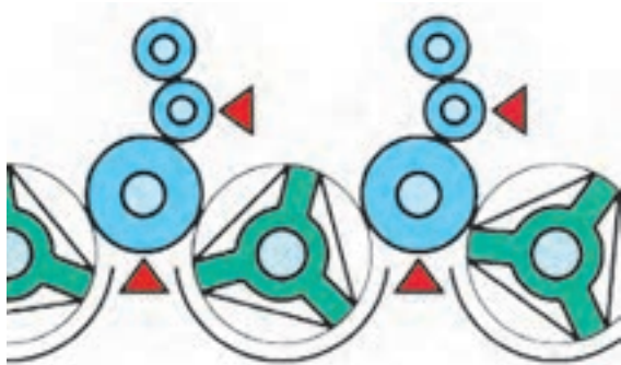
شکل ۳-۵- تغذیه CPTRONIC ... سیستم شست و شوی اتوماتیک
