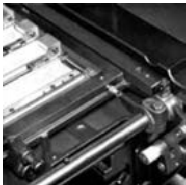
شکل ۳۷-۴- میله ضربه‌زن برای دستگاه‌های شماره‌زنی افقی
