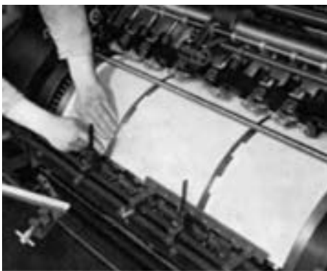
شکل ۴-۴۱- پرفراژ منقطع با نوارهای بریده شده؛ نصفه سمت چپ بروس سیلندر به منظور تنظیم نوار برداشته شده است.
