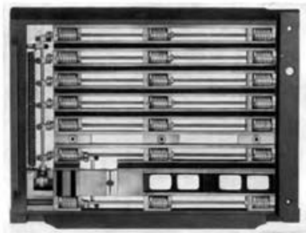
شکل ۳۲-۴- دستگاه شماره‌زنی افقی بسته شده، کلید غلتکی سمت چپ
