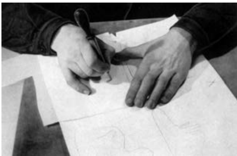
شکل ۲۳-۴- بریدن تکه جهت زیرسازی با تیزبُر (کاتر)
