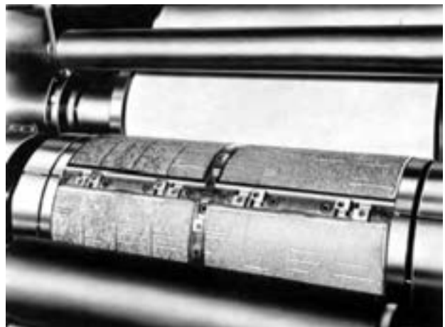
شکل ۱۷-۲- ماشین روتاسیون رول با فرم‌های بسته شده جهت چاپ روزنامه
