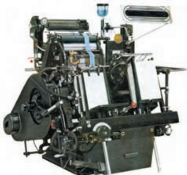
شکل ۲-۲- ماشین تیگل، سیستم بوستون معروف به ملخی
