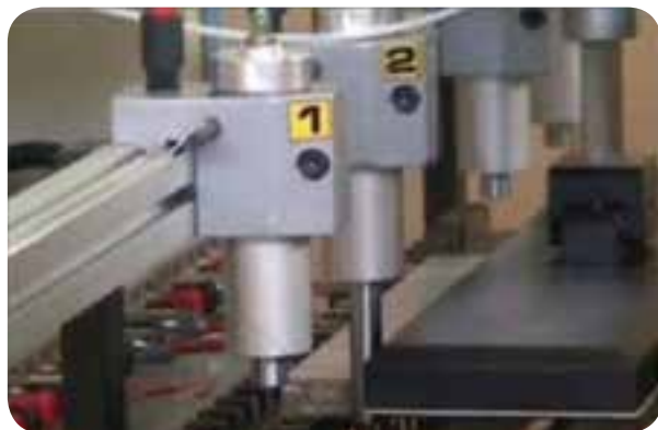
شکل ۳-۷ - قطعه کار، توسط جک‌ها گونیا شده است.
