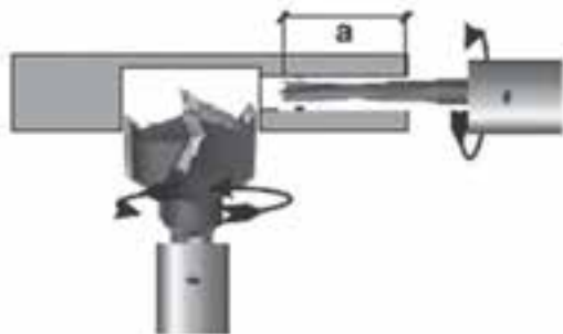
شکل ۱۴-۳- ابتدا مته افقی سوراخ کاری را انجام می‌دهد و سپس مته عمودی
