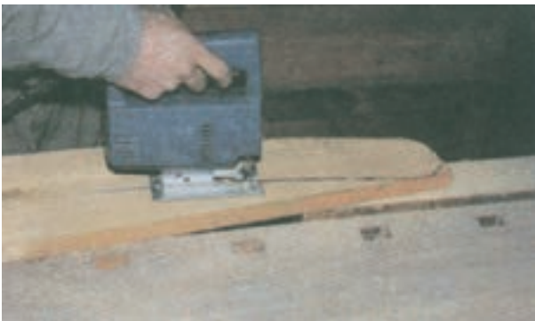
شکل ۱۴-۳۵- خط شابلون در قسمت بریده شده به قطعه اصلی دیده می شود.
