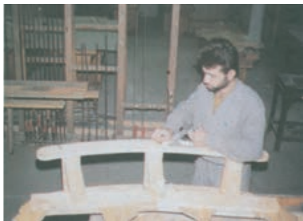
شکل ۸۱-۱۴- عملیات پرداخت کاری نهایی الکلنگ مونتاژ شده
