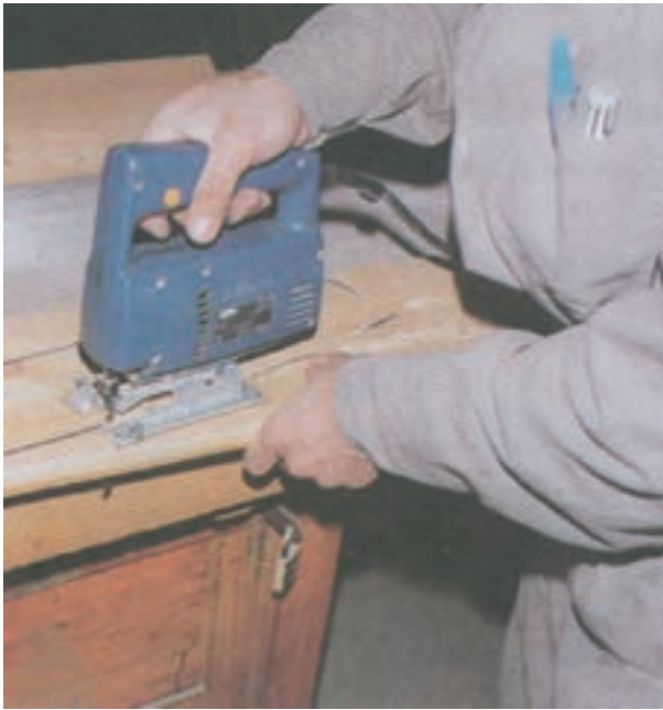
شکل ۱۴-۳۳- برش کاری قوس خارجی قطعه شماره ۱۱
