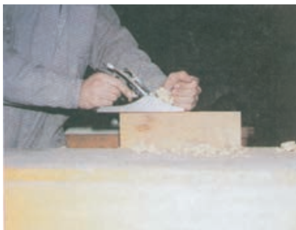
شکل ۴۵-۱۴- رندیدن ضخامت قطعه شماره ۵ با رنده آهنی
