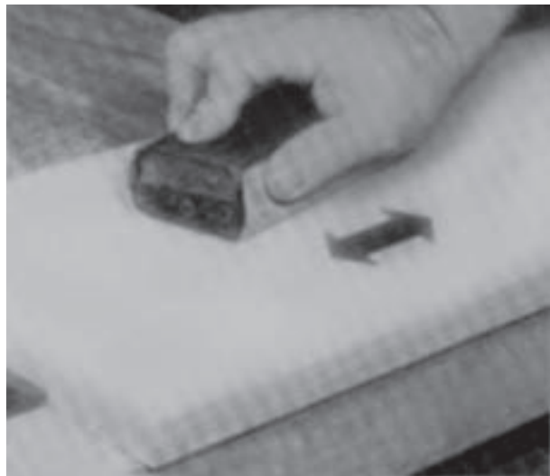
شکل ۷۰-۱۴ پرداخت کاری قطعات الاکلنگ به وسیله سنباده
