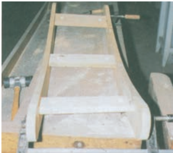
شکل ۷۲-۱۴- مونتاژ کردن مقر خمیده پایه با چکش لاستیکی و پیچ دستی
