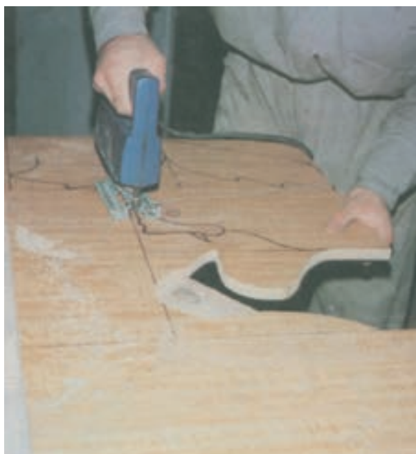
شکل ۲۷-۱۴- عمل برش سر خروس و نحوه استقرار هنرجو
