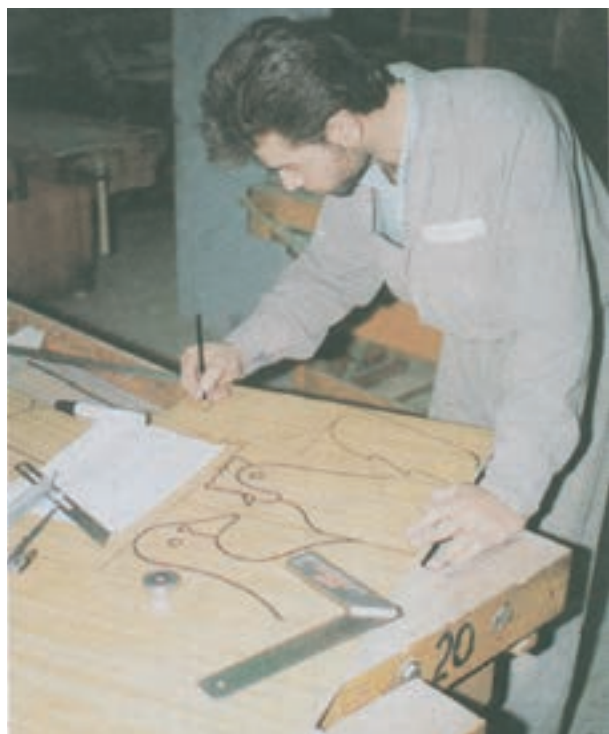
شکل ۱۴-۱۵- هنرجو در حال طراحی قطعات الاکلنگ روی M.D.F روکش شده
