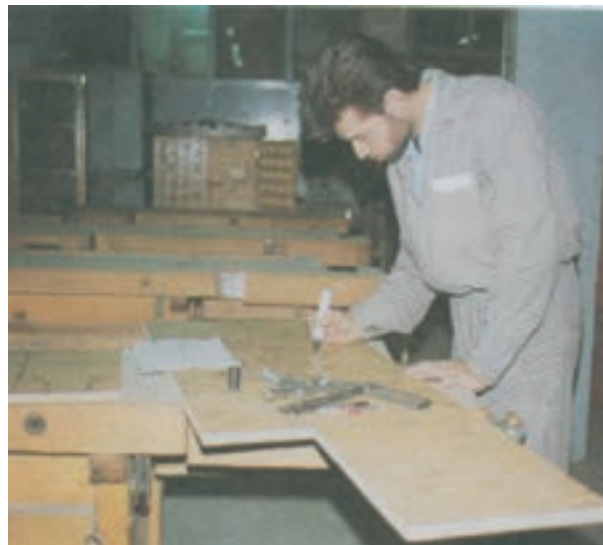
شکل ۱۴-۲۴- خط‌کشی قطعات الاکلنگ روی ورق M.D.F به وسیله شابلون
