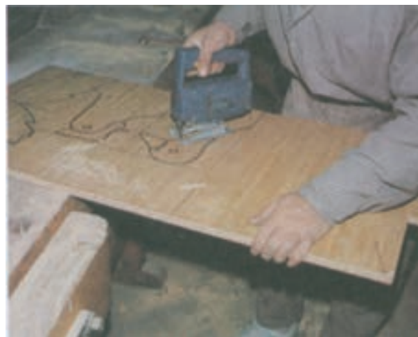
شکل ۱۴-۲۵- عمل برش نوپان به وسیله اره عمودبر جهت برش سر مرغ که از پایین صفحه شروع شده
