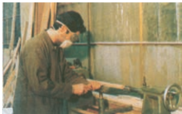
شکل ۱۳-۱۳- طرز کار با ماشین خراطی
