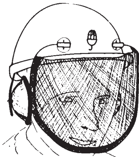
شکل ۲۴-۱۳- در هنگام عملیات خراطی باید از عینک حفاظتی مخصوص استفاده نمود.
