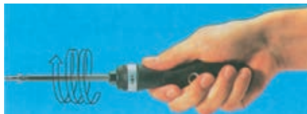
شکل ۹-۱۲- بستن سریع پیچ با آچار پیچ‌گوشتی خودکار
