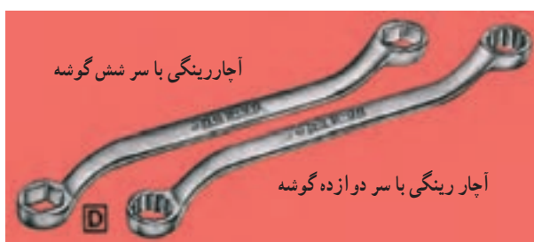
شکل ۱۲-۲۸- آچار رینگی با سر شش و دوازده گوشه
