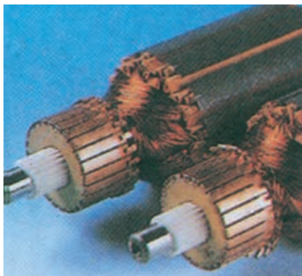
شکل ۱۲-۱۸ دو عدد کلکتور دریل برقی ساده و شارژی
