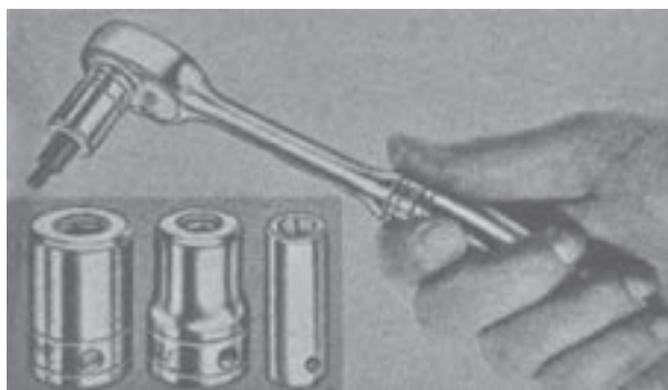
شکل ۱۲-۳۱ نحوه‌ی کاربرد آچار بوکس جفجغه‌ای
