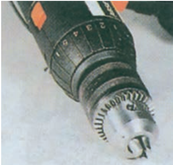
شکل ۱۲-۱۶- دریل برای سرعت کم تنظیم شده
