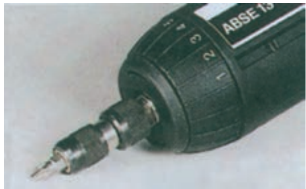
شکل ۱۲-۱۵- دریل پیچ‌گوشتی برای سرعت زیاد تنظیم شده
