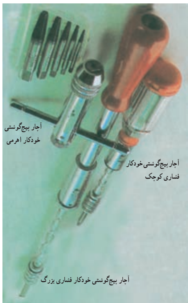
شکل ۱۱-۱۲- آچار پیچ‌گوشتی خودکار فشاری
