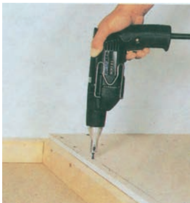
شکل ۱۲-۱۲- نحوه‌ی کاربرد دریل پیچ‌گوشتی برقی دستی ساده
