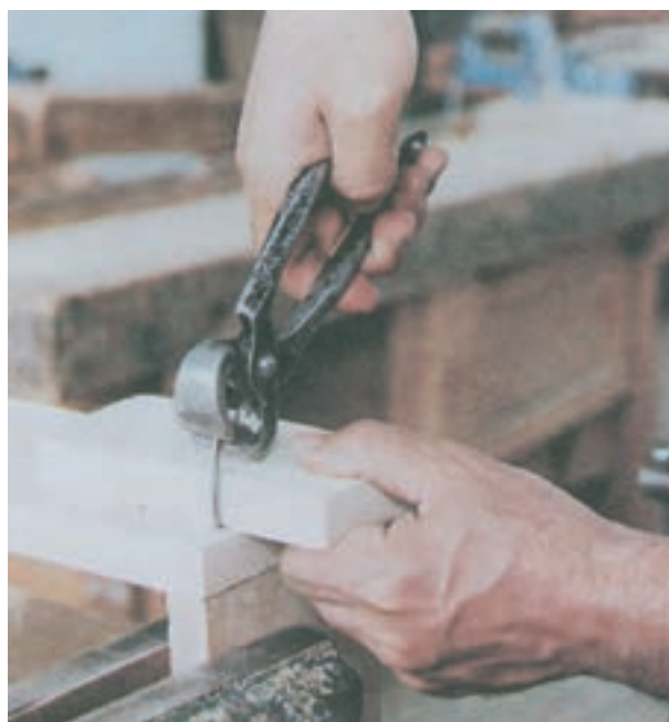
شکل ۱۱-۱۸- طریقه‌ی استفاده از گازانبر
