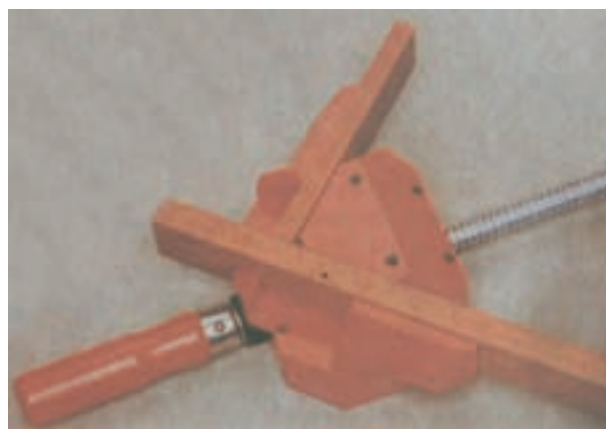
شکل ۱۶-۱۰- یک نوع گیره مخصوص قاب
