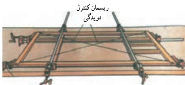
شکل ۱۰-۳۰- با تنگ‌های بزرگ می‌توانید با آوردن فشار یکنواخت از دو جهت کار را به‌خوبی بچسبانید (سطح قاب‌ها پیچیده نشوند).
