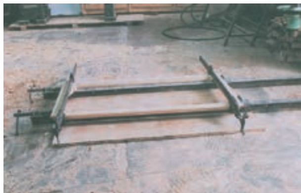
شکل ۱۰-۲۸. برای چسباندن درهای بزرگ از تنگ‌های بلند برای قیدهای طولی (بلند) و از تنگ‌های متوسط برای قیدهای عرضی استفاده کنید.
