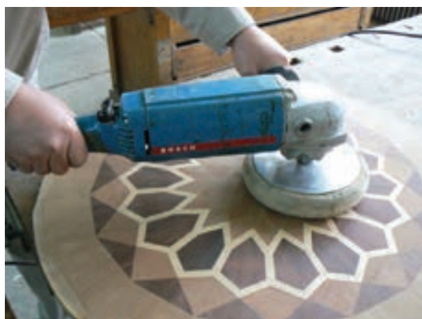
شکل ۹-۲۰- ماشین سنباده دیسکی را می‌توانید به عنوان پولیش کاری در رنگ‌های پولیستر به کار برید.
