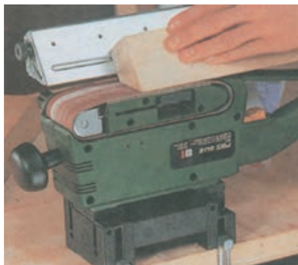
شکل ۹-۱۴- با استفاده از تکیه گاه قابل تنظیم می توان جوب ها را تحت هر زاویه به وسیله ماشین سنباده نواری پرداخت کنید.
