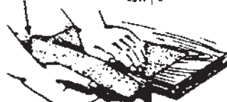
شکل ۹-۷- نحوه‌ی عمل قطع کردن سنباده، سنباده کاری باید در جهت الیاف چوب باشد.
