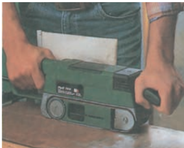
شکل ۹-۱۱- کار را محکم به میز کار ببندید.
