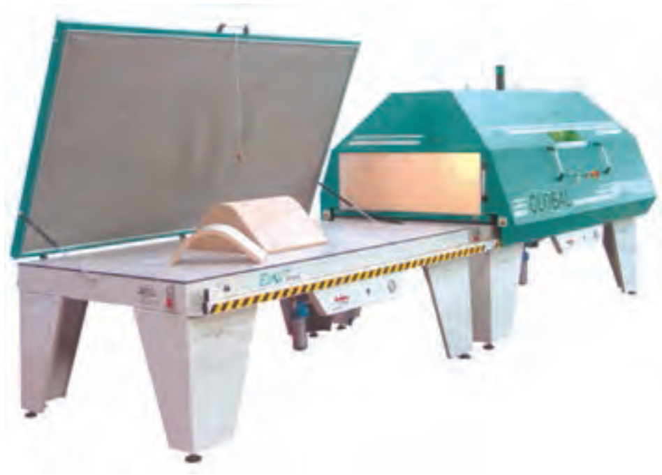
شکل ۹-۷- پرسهای خاص جهت قطعات ویژه با روکشهای آکریلیک یا سنگهای مصنوعی روکشهای آکریلیک
