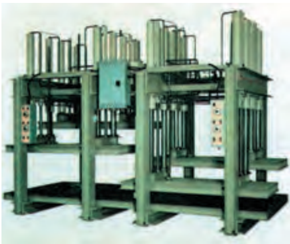
پرس سه قطعه‌ای با پیچ و فلکه جهت چسبانیدن روکشهای چوبی
