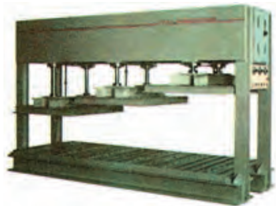
پرس سه قطعه‌ای هیدرولیک برای پرس کردن قطعات چوبی به ابعاد کوچک
