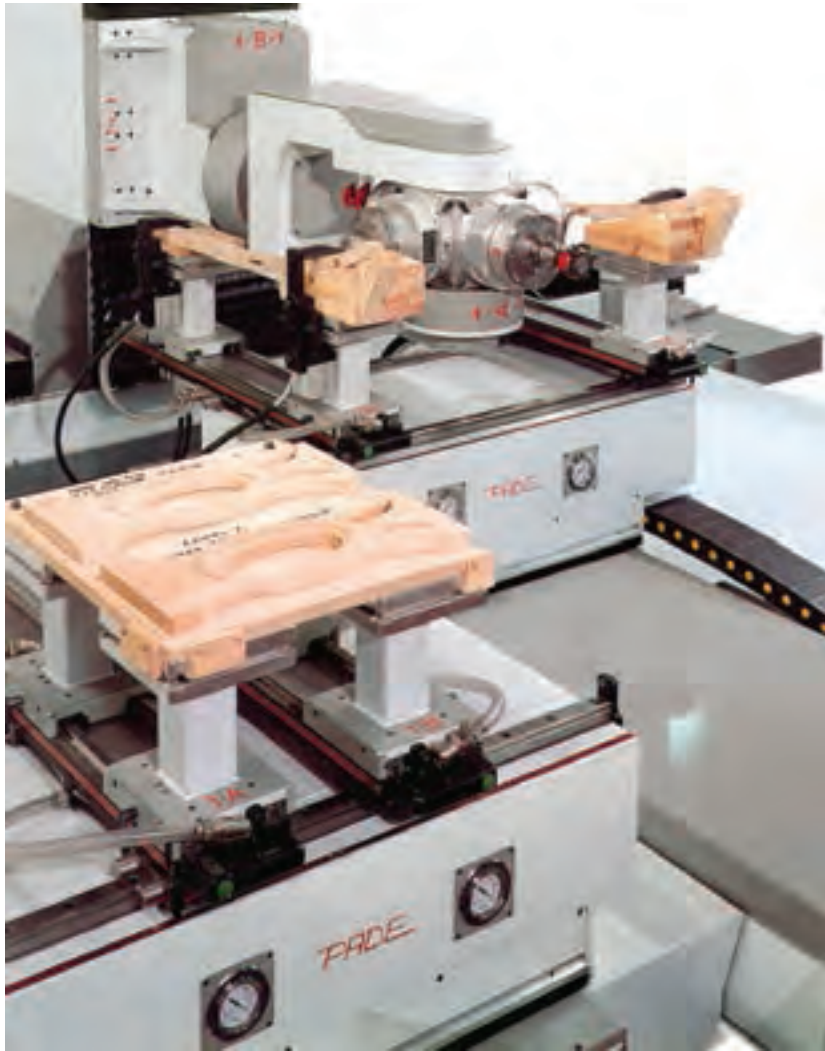
شکل ۲۸-۸- نمونه کار ابزار خورده کامل که آماده مونتاژ می‌باشد.
