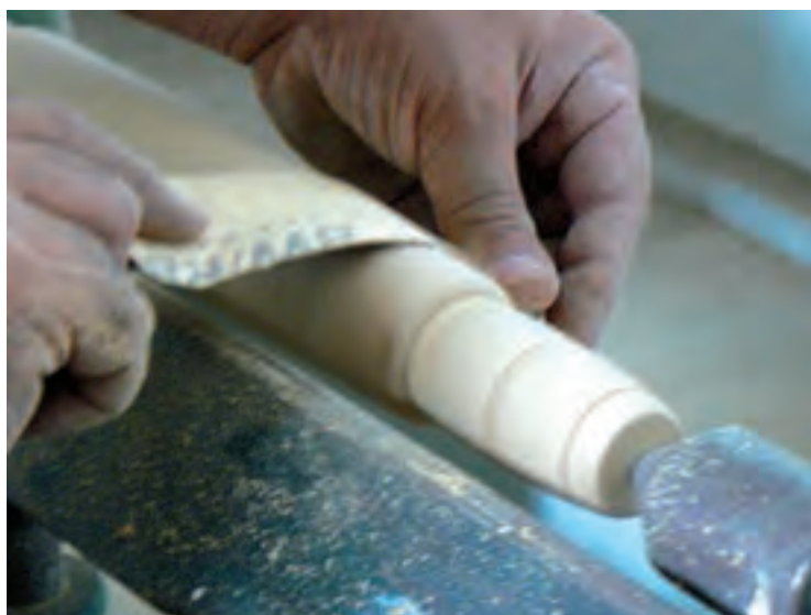
شکل ۹-۵- نحوه سنباده زدن با ماشین خراطی
