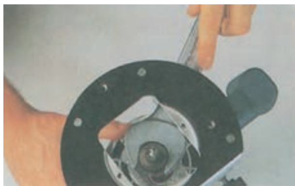
شکل ۸-۸- نحوه‌ی باز و بستن تیغ فرز به کمک آچار دوسر تخت
