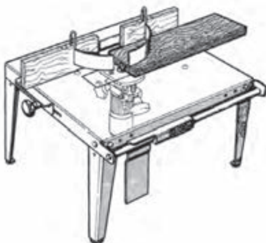
شکل ۸-۵۲- استقرار فرز زیر صفحه میز
