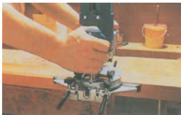
شکل ۳۰-۸- نحوه‌ی فرزکاری لبه کار با استفاده از گونیا ماشین
