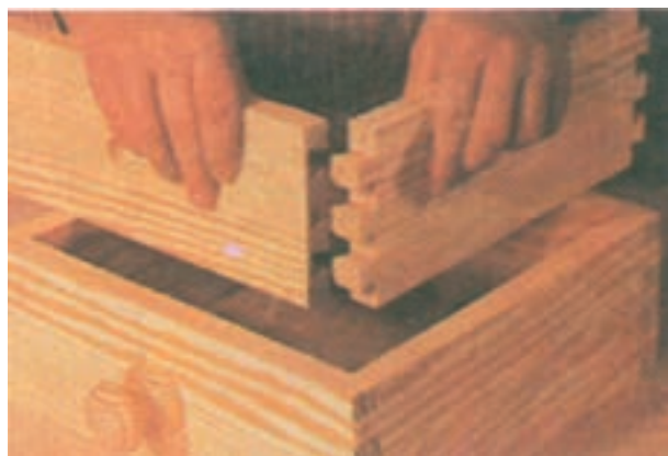
شکل ۸-۲۴ پس از ساخت اتصال دم چلچله با استفاده از شابلن و ماشین فرز، آن‌ها را مطابق شکل برای ساخت جعبه در داخل جاسازی کنید.
