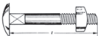
شکل ۱۰۳-۲ پیچ اتاقی با سر گرد و مهره چهارگوش
