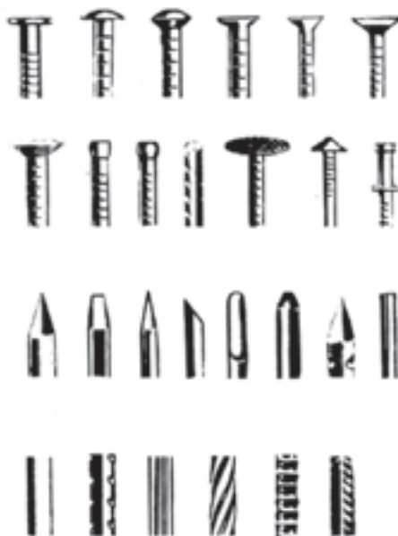
شکل ۲-۹۱- سرهای مختلف، ساق‌ها و نوک انواع میخ‌ها
