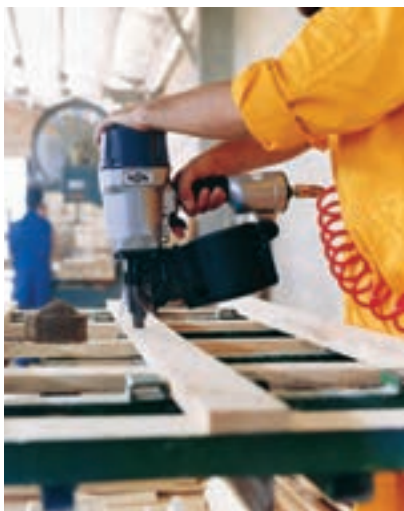
شکل ۸۱-۲- ب- دستگاه میخ کوب شانهای
