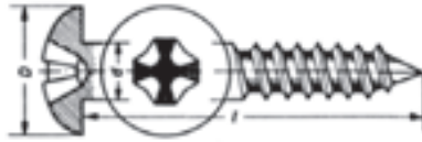
شکل ۲-۹۶- پیچ سرگرد با شکاف چهارسو
