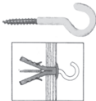
شکل ۲-۱۰۸- پیچ قلاب‌دار عمودی
