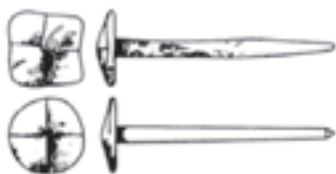
شکل ۷۹-۲- میخ کوره کاری شده
