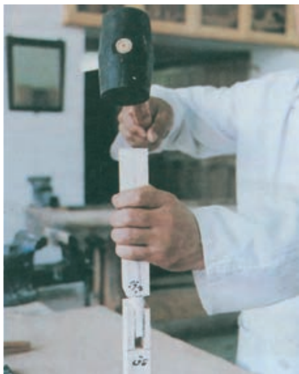
شکل ۷-۱۹- طریقه متصل کردن فاق و زبانه
