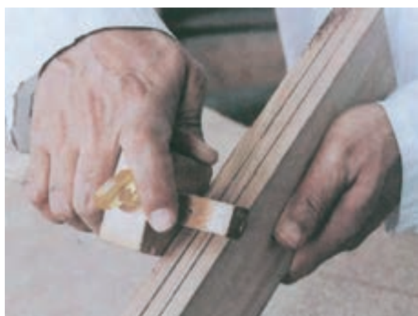
شکل ۷-۴۳- خط‌کشی کنشکاف قلیف با خط‌کش تیره‌دار
