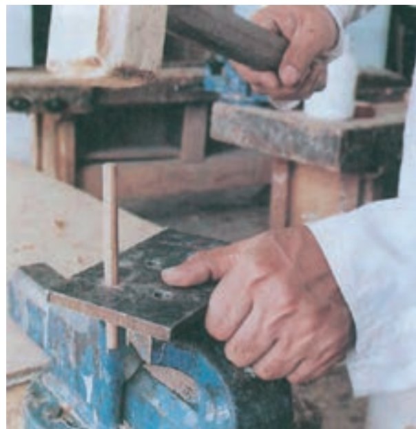
شکل ۷-۵۵- عبور دادن میخ چوبی از آهن دوپل
