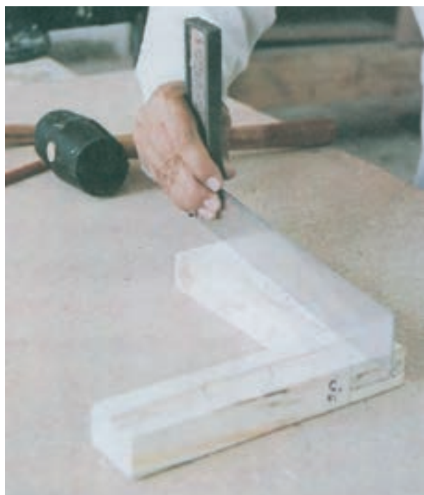
شکل ۷-۲۲- طریقه‌ی کنترل اتصال گوشه‌ای
