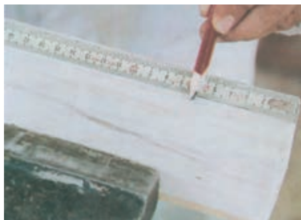
شکل ۷-۶- اندازه اتصال را روی چوب علامت‌گذاری کنید.
