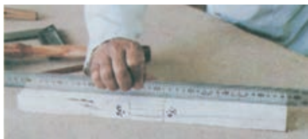
شکل ۷-۲۰- فاق و زبانه ساخته‌شده را کنترل کنید.
