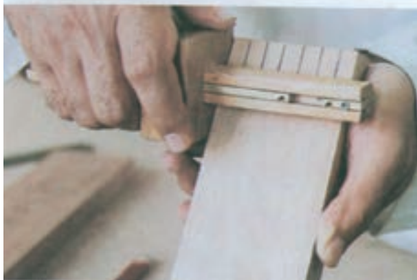
شکل ۷-۲۷- طریقه خط‌کشی اتصال انگشتی به وسیله خط‌کش تیره‌دار
