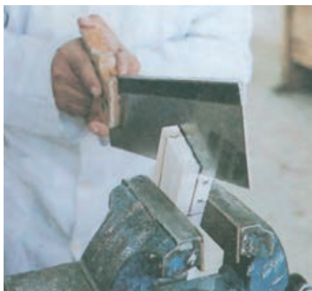
شکل ۷-۱۰- طریقه برش اتصال نیم و نیم
