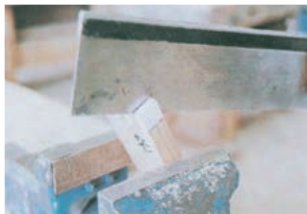
شکل ۷-۲۹- عمل برش با زاویه 45^\circ درجه
