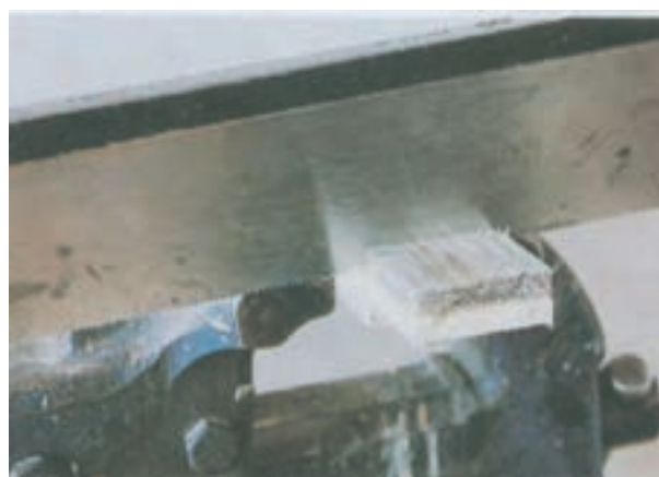
شکل ۷-۱۷- قطع کردن دو بر زبانه
