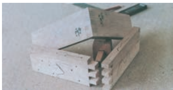
شکل ۳۹-۷-۱ — اتصال انگشتی ساده
