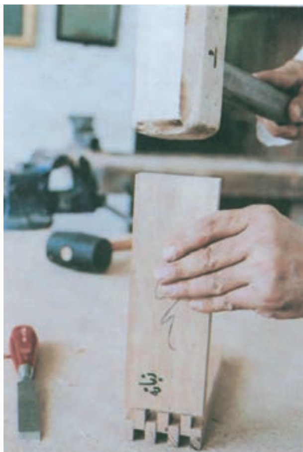
شکل ۳۷-۷-۱ — طریقه داخل کردن فاق و زیانه
