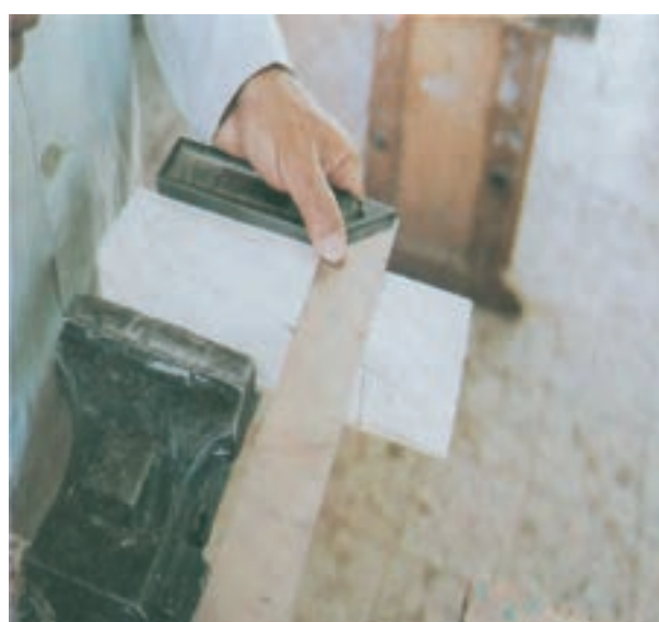
شکل ۷-۷- به‌وسیله گونیا چوب را خط‌کشی کنید.
