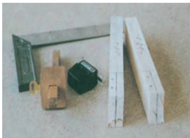
شکل ۷-۹- چوب‌های خط‌کشی‌شده برای اتصال نیم و نیم
