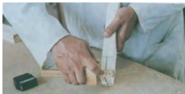
شکل ۷-۸- به‌وسیله‌ی تیره‌دار محل اتصال را خط بکشید.
