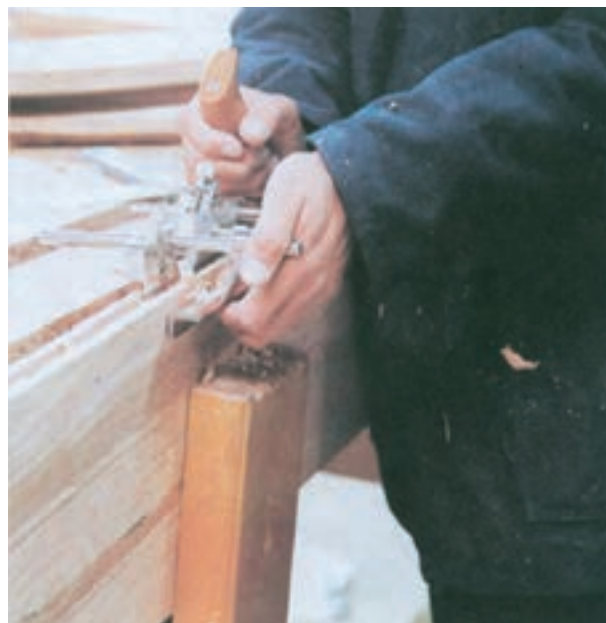
شکل ۷-۴۴ رنده کردن به وسیله‌ی رنده کنشکاف
