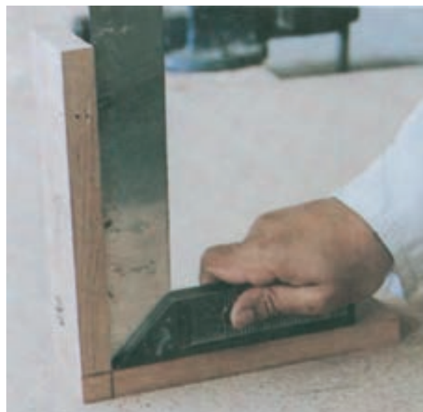
شکل ۳۸-۷-۱ — کنترل کردن اتصال ساخته شده
