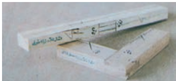
شکل ۷-۲۳- فاق و زبانه به صورت ساده و گوشه‌ای
