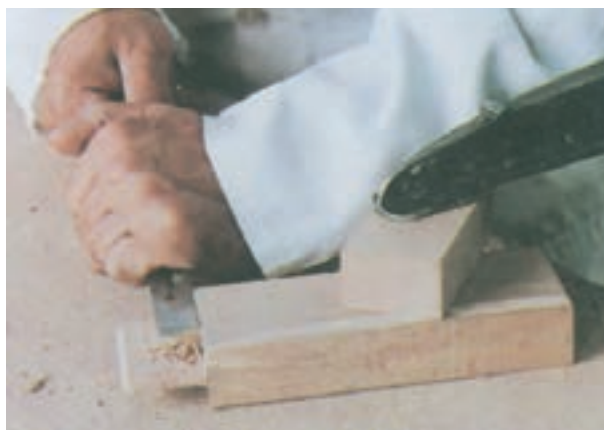
شکل ۶-۴ صاف کردن اطراف زبانه با مغار
