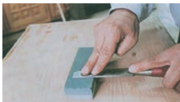
شکل ۶-۳۶- طریقه برطرف کردن پلیسه
