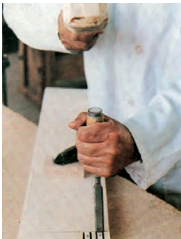
شکل ۶-۸- نحوه‌ی ضربه زدن به سر دسته‌ی مغار
