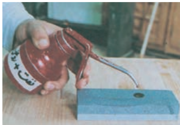
شکل ۶-۳۴- روغن زدن یا نفت زدن روی سنگ
