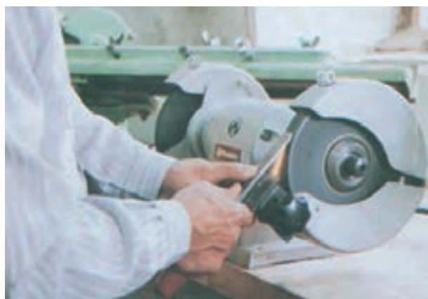
شکل ۶-۳۲- طریقه‌ی تیزکردن تیغه‌ی مغار
