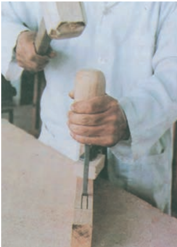
شکل ۶-۱۸- طریقه ی کاربرد اسکنه
