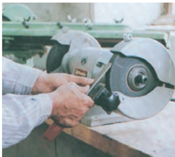
شکل ۶-۳۱- تنظیم تکیه‌گاه برای تیزکردن مغار
