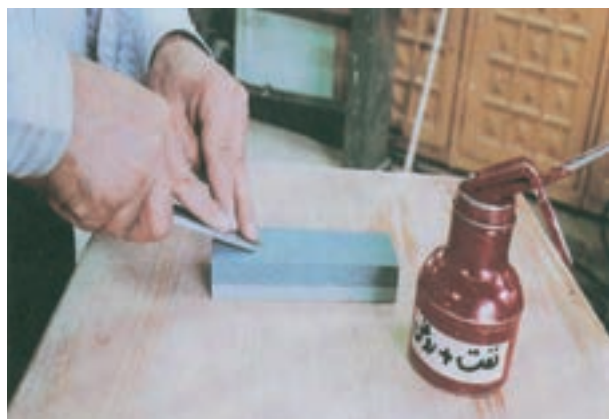
شکل ۶-۳۵- طریقه کشیدن تیغ مغار روی سنگ نفت
