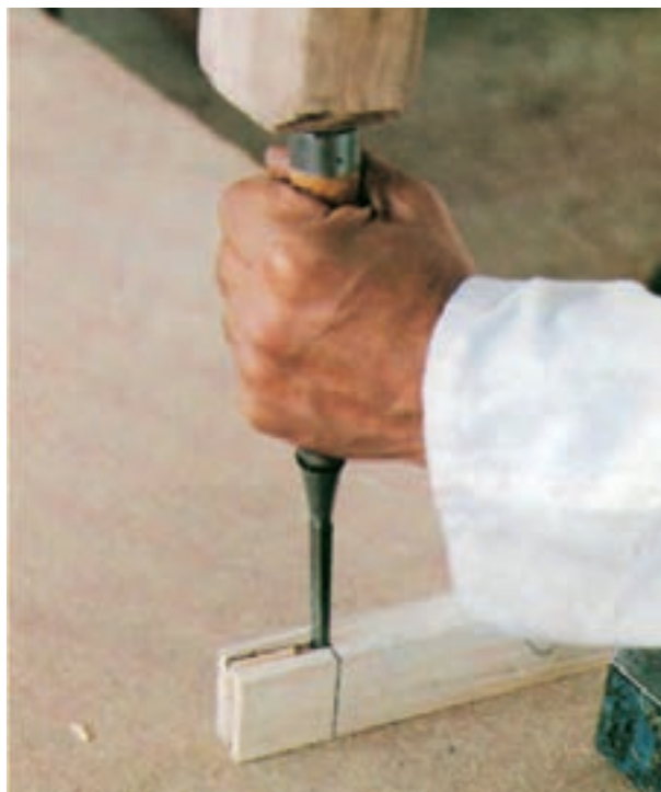
شکل ۶-۳ استفاده از مغار
