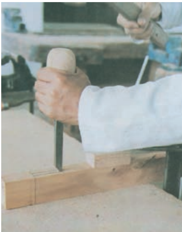
شکل ۶-۱۹- اسکنه عمود قرار داده شده
