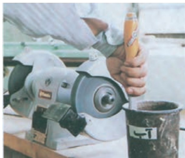
شکل ۶-۳۳- لبه تیغه را به طور مرتب با آب خنک کنید تا نسوزد
