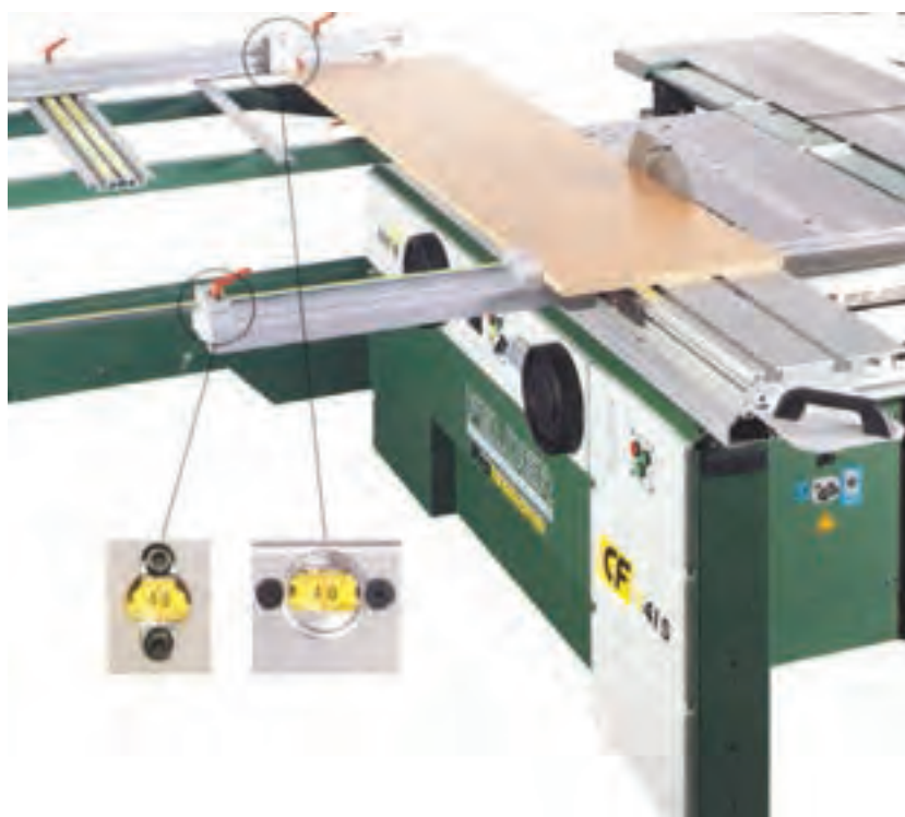
شکل ۱-۳۸- ماشین اره گرد صفحه بر با میز کمکی کشویی
