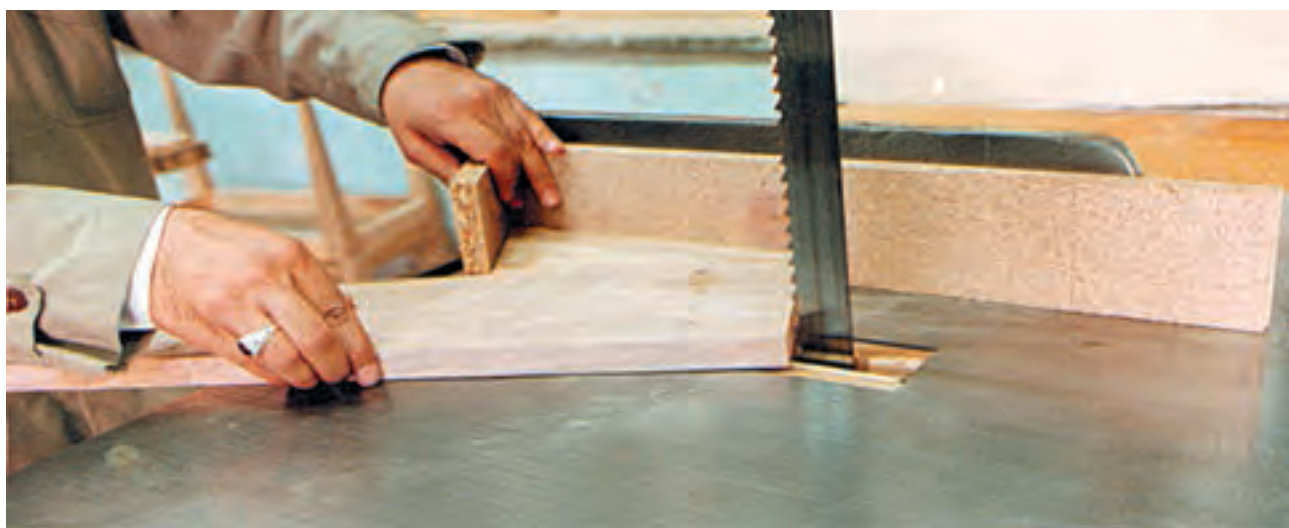
شکل ۱۵-۱- روش استفاده از شابلون برای برشهای مثلی
