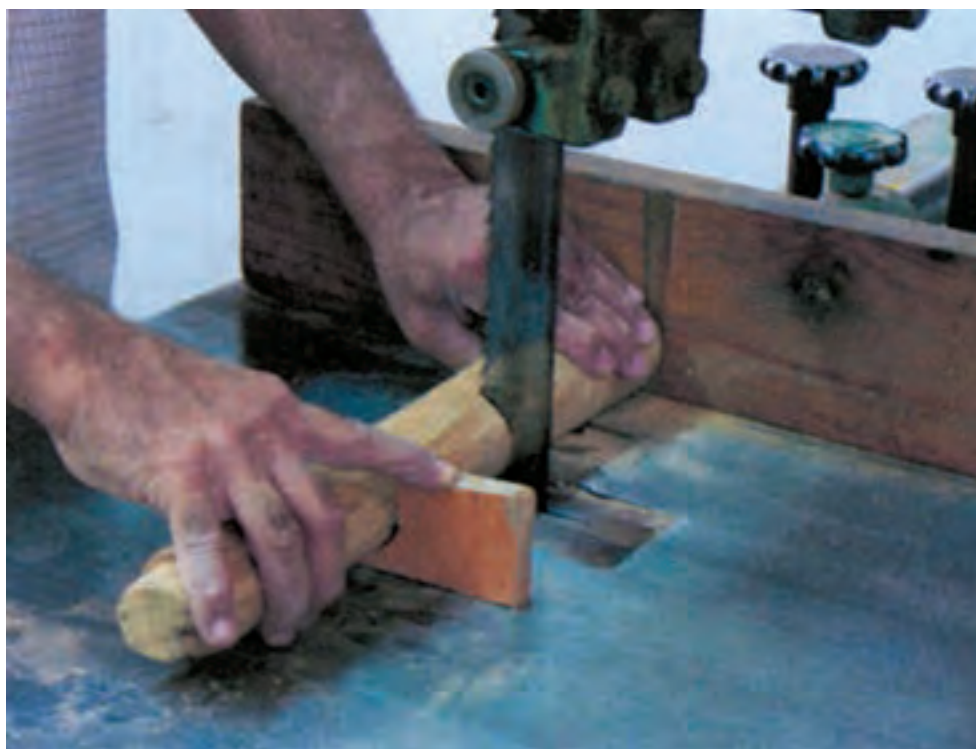
شکل ۱۴-۱- روش استفاده از شابلون در برش چوبهای استوانه ای
