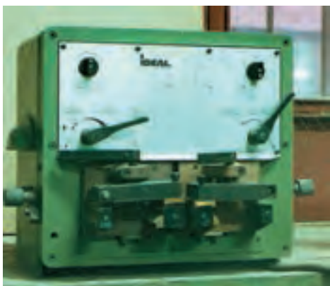
شکل ۱۲-۱- دستگاه جوش تیغه اره نواری
