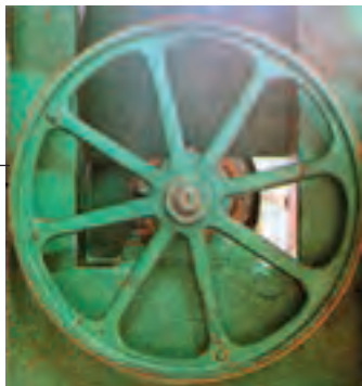
شکل ۴-۱- فلکه پایین اره نواری به همراه بانداز
