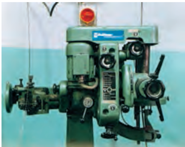
شکل ۸-۱- دستگاه چپ و راست و تیزکن اره نواری
