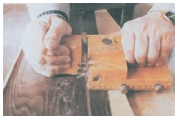
شکل ۵-۵۴- نحوه ایجاد شیار برای نصب مغزی
