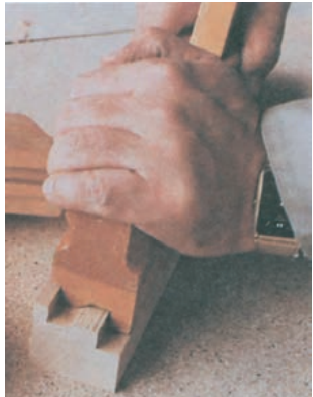
شکل ۵-۵۵- طریق ابزار زدن به چوب
