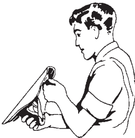
شکل ۵-۵- نحوه ی تنظیم رنده
