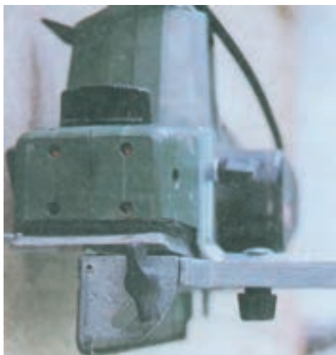
شکل ۵-۶۷- تنظیم رنده برای رنده کردن سطوح تخت
