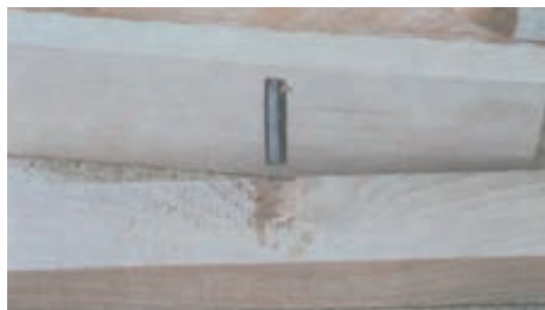
شکل ۲۲-۵- کندگی در سطح چوب
