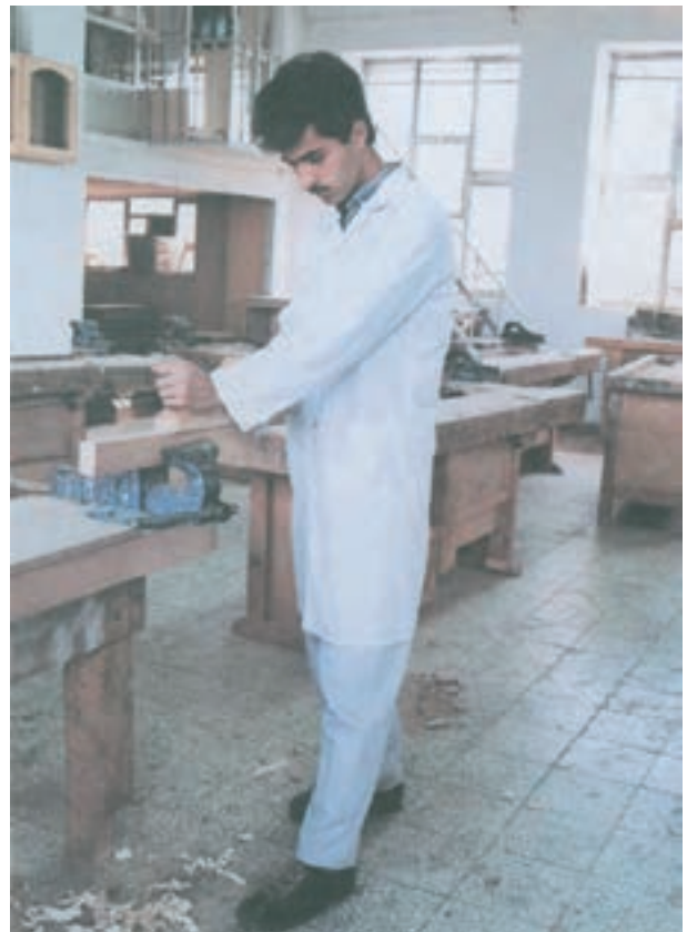
شکل ۵-۲- نحوه ی رنده کاری
