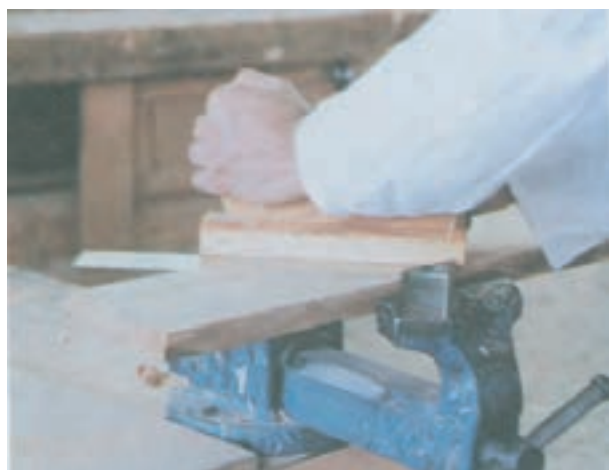
شکل ۵-۳۳ حرکت دادن مورب رنده خشی
