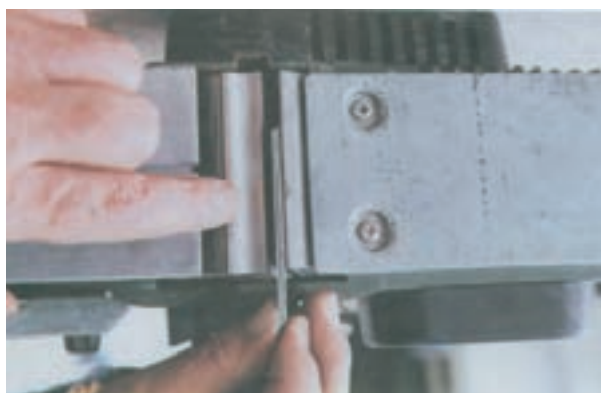
شکل ۵-۶۳- نحوه‌ی جازدن تیغ‌هی رنده
