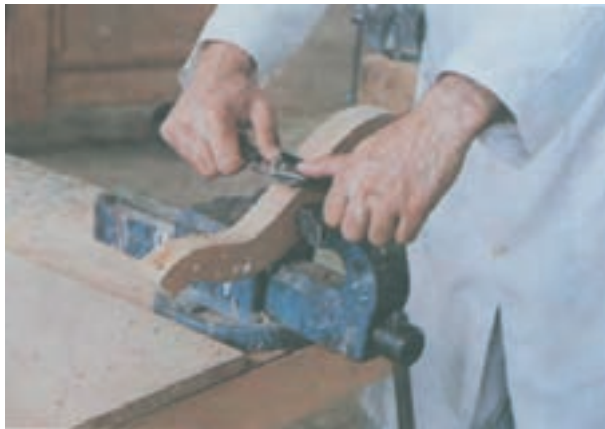
شکل ۵-۵۷- نحوه‌ی استفاده از رنده بال‌کبوتری
