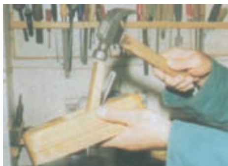
شکل ۱۰-۵- تنظیم تیغه با ضربه‌ی چکش
