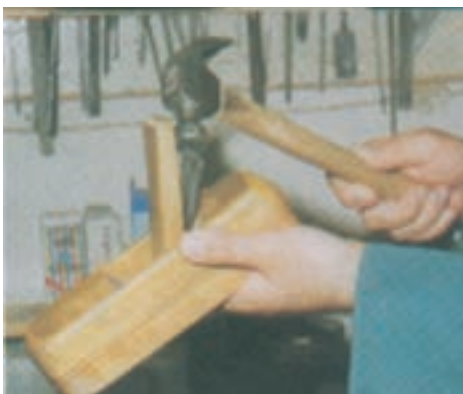
شکل ۱۱-۵- تنظیم جانبی تیغه
