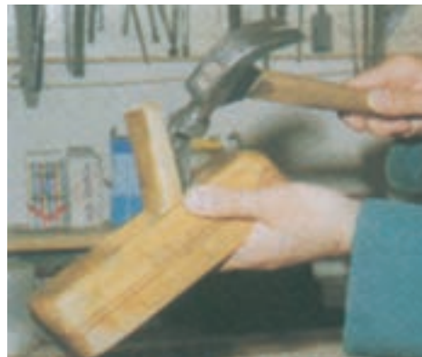
شکل ۱۱-۵- تنظیم جانبی تیغه
