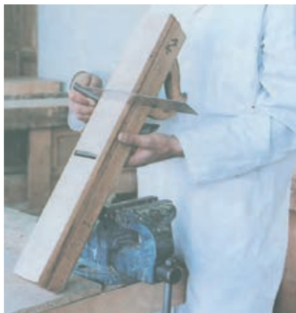
شکل ۵-۳۰ کنترل عرضی سطح رنده
