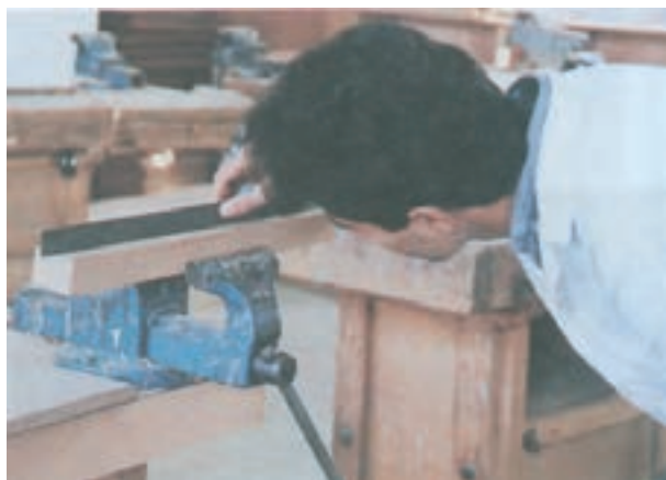
شکل ۲۳-۵- کنترل صافی سطح رنده شده
