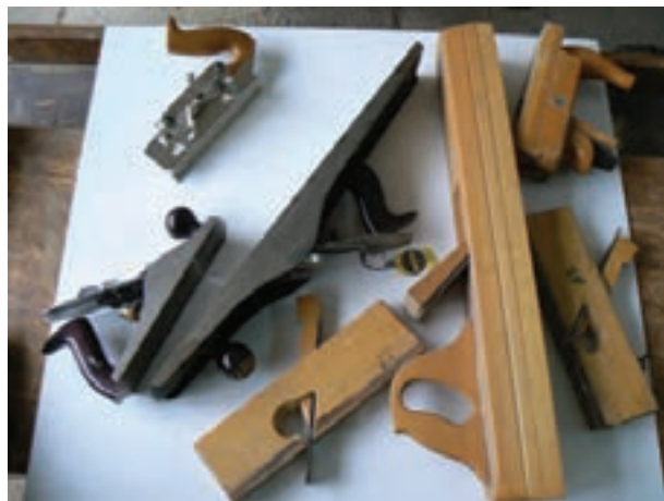
شکل ۵-۱ - انواع رنده‌ها
