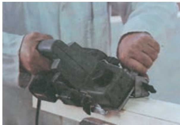
شکل ۵-۷۶ طریقه پخ زدن به چوب
