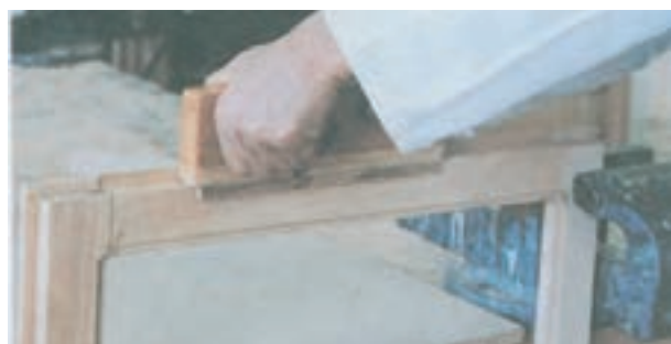
شکل ۳۸-۵ دوراوه زدن
