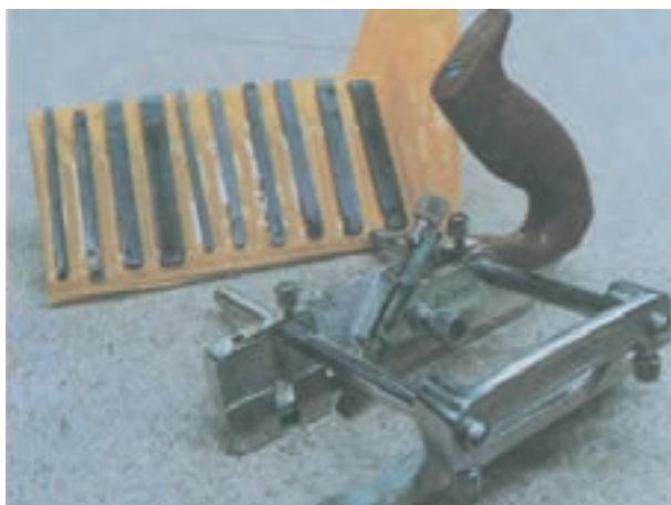
شکل ۵-۵۲- رنده کنشکاف با تیغه‌های مختلف
