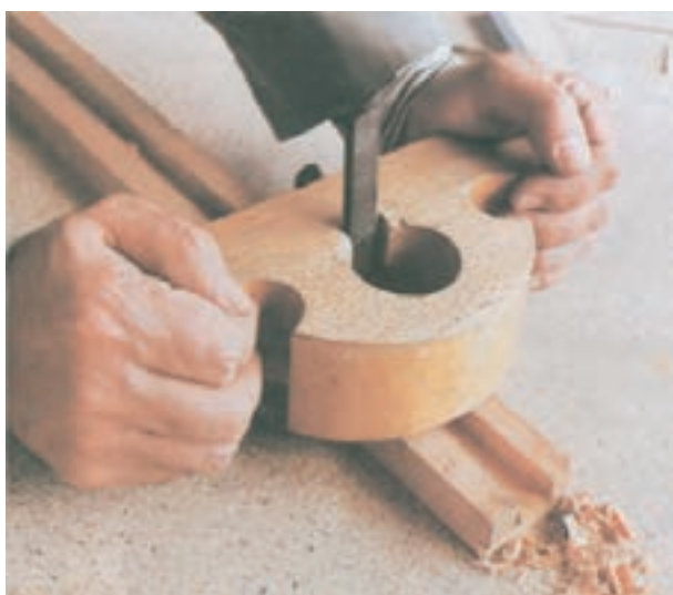
شکل ۴۹- نحوه ایجاد کنشکاف طرح فرنگ با رنده چوبی مخصوص
