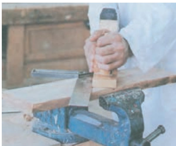
شکل ۳۴-۵ نحوه‌ی رنده کردن مجدد با رنده خشی
