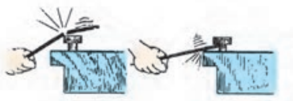
شکل ۴۸-۳- استفاده غلط از سوهان
