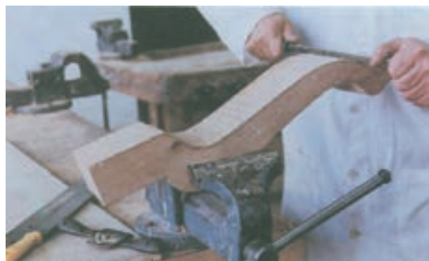
شکل ۵-۳- چوبساکاری یک پایه فرم‌دار
