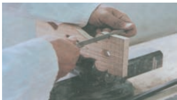
شکل ۳-۲۵ - به کارگیری سوهان سه گوش
