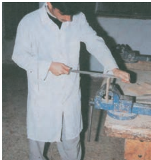
شکل ۳-۳- نحوه‌ی ایستادن جهت سوهان‌کاری و چوبساکاری
