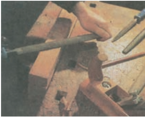
شکل ۳-۳۱- چوبساکاری قطعات ساده
