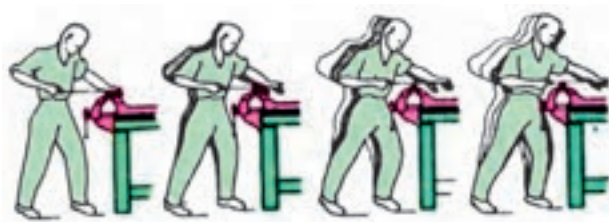
شکل ۱۱-۳ حرکت نوسانی بدن در سوهان کاری و چوبساکاری
