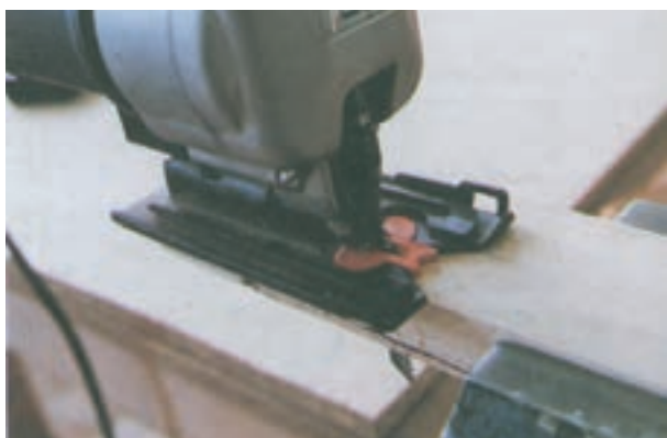
شکل ۵۳-۲ استفاده از قطعه هدایت تیغه در اره چکشی عمودی
