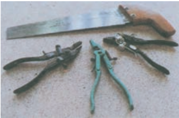
شکل ۲-۶۴- بستن چپ و راست کن اره
