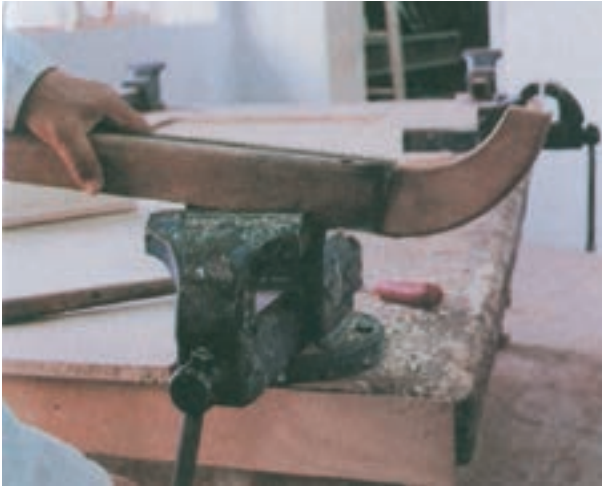
شکل ۲-۶۳- بستن تنگ همراه اره به گرهی رومیزی
