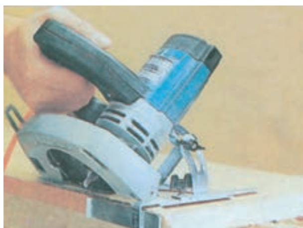
شکل ۲-۲۹- برش تحت زاویه به وسیله‌ی گونیای دستگاه
