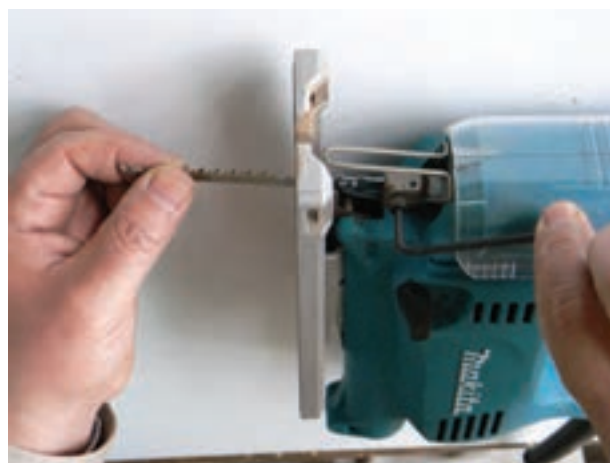
شکل ۴۵-۲ بازکردن تیغه به وسیله‌ی آچار آلن
