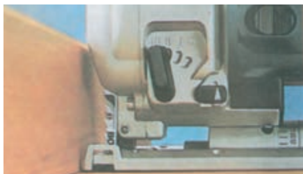
شکل ۲-۳۷- کلید تغییر دور در اره‌ی چکشی
