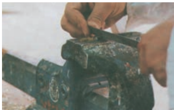
شکل ۲-۶۸ نحوه‌ی به دست‌گیری سوهان در تیز کردن اره‌ها
