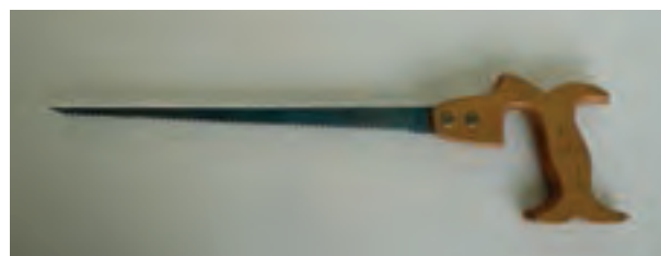
شکل ۱۷-۲-اره نوکی با تیغه متحرک
