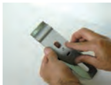
شکل ۱۶-۳- پشت بند تیغ روی تیغ رنده (در رنده دو تیغ)
