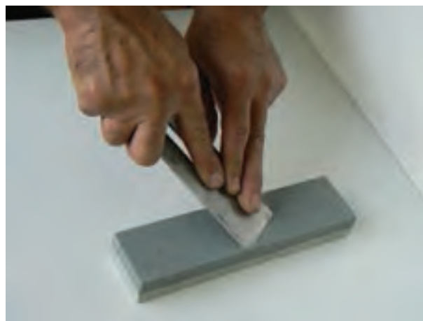
شکل ۳۴-۳- روش سنگ نفت زدن تیغه رنده
