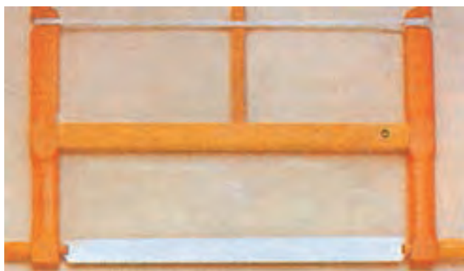
شکل ۲۲-۲-اره کلافی با تیغه شکاف‌زن
