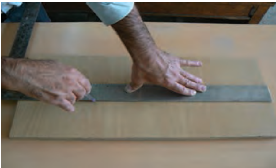
شکل ۹-۱- بر راستی و روش استفاده از آن
