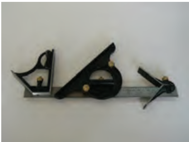
شکل ۱-۵- قسمتهای مختلف یک گونیای ساده و مرکب
