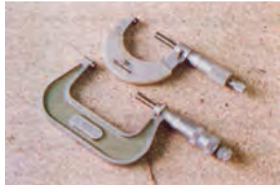
شکل ۱-۱۶- میکرومتر و قسمت‌های مختلف آن
