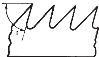
شکل ۱۰-۲- زاویه برش کمتر از ۹۰ درجه
