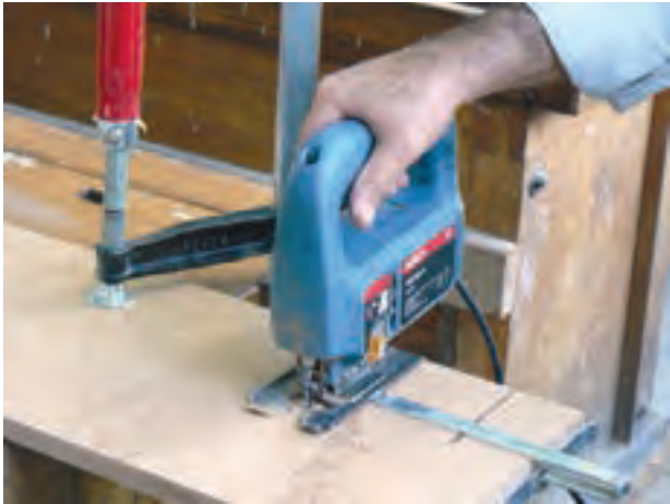
شکل ۲-۲۹- استفاده از گونیا در برش
