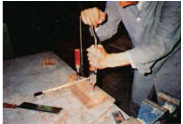
شکل ۴-۵۳- سوراخکاری با استفاده از شابلون برای اتصال با دویل
