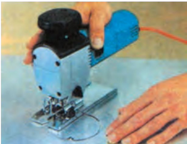
شکل ۲-۳۰- اره عمودبر برقی در حال قوس‌بری
