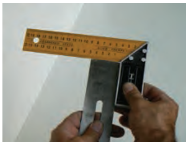
شکل ۳۳-۳- گونیایی کردن سرتیغه رنده
