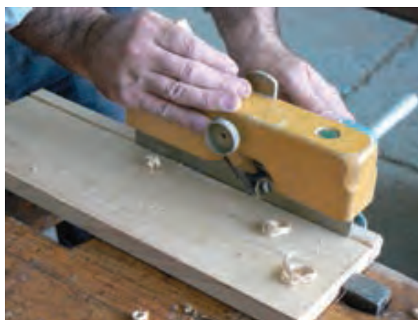
شکل ۳-۲۸ رنده چوبی کنشکاف قابل تنظیم
