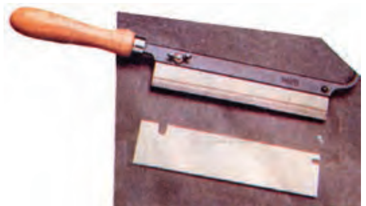
شکل ۲-۱۳- اره ظریف بر با دسته متحرک
