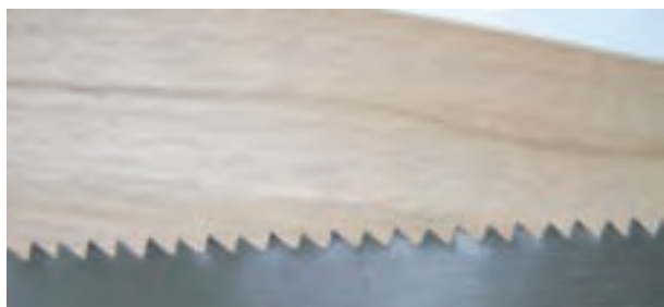
شکل ۱۱-۲- دندانه های اره شکاف زن
