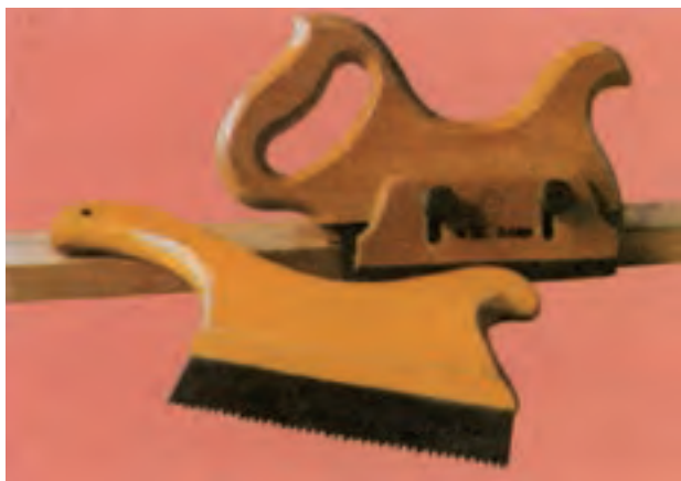
شکل‌های ۲۰ و ۲۱-۲-اره گرات با تیغه ثابت و متحرک
