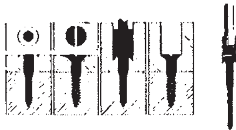
شکل ۴-۵۳- سوراخکاری با استفاده از شابلون برای اتصال با دویل
