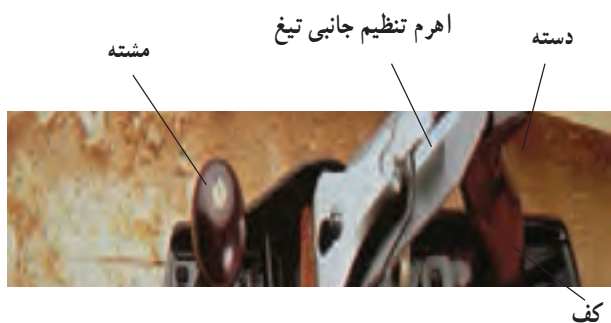
شکل ۱۸-۳- قسمتهای مختلف یک رنده آهنی
