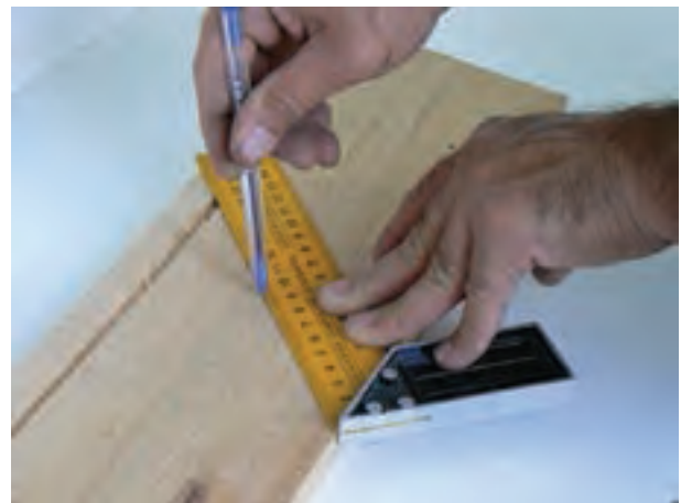
شکل ۱-۵- قسمتهای مختلف یک گونیای ساده و مرکب
