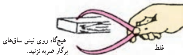
شکل ۳۰-۱ تنظیم ظریف پرگار اندازه گیر خارجی
