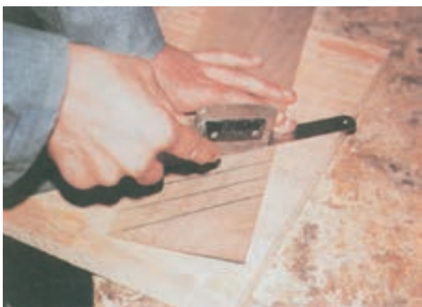
شکل ۲-۱۹- برش روکش با اره‌ی روکش‌بر
