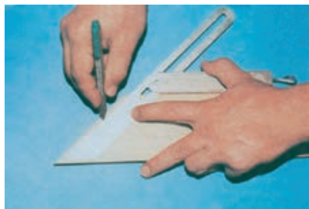
شکل ۱۸-۱- انتقال زاویه بر روی قطعه مورد نظر
