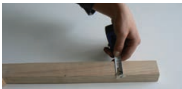
شکل ۱-۶- اندازه‌گیری در خارج کار
