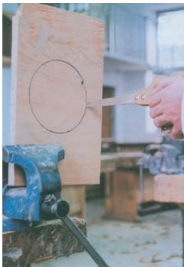
شکل ۱۲-۲- برش قطعه کار به وسیله‌ی اره نوکی
