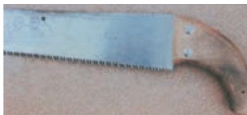
شکل ۲-۴- اره با دندانه رو به عقب
