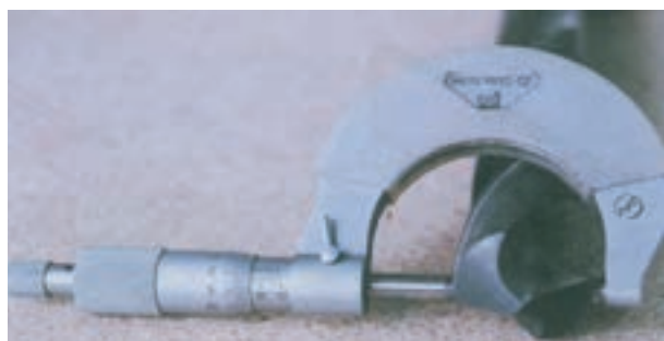
شکل ۱-۴۶- اندازه‌گیری به وسیله میکرومتر
