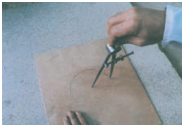
شکل ۱-۲۹ ترسیم دایره به وسیله‌ی پرگار معمولی
