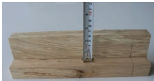
شکل ۱-۵- نحوه‌ی اندازه‌گیری برای داخل کار
