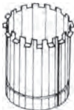
شکل ۶-۲۴ خمکاری فاق‌ها به صورت یک در میان
