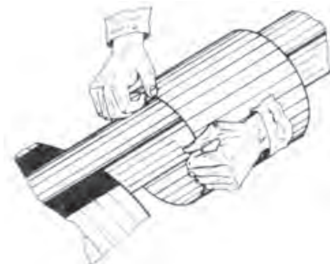
شکل ۶-۲۰ گرد و استوانه کردن گسترش
