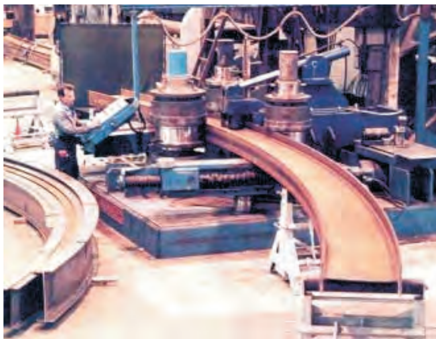
شکل ۵-۱۳ خمکاری دستی پروفیل‌ها
