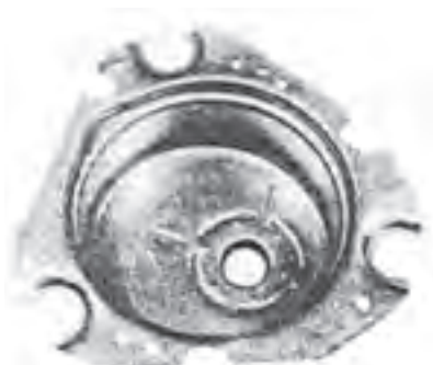
شکل ۲-۳۸ ایجاد برجستگی برای جوشکاری
