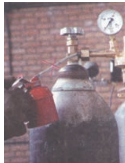
شکل ۱۰-۳ کار اشتباه روغن‌کاری کپسول اکسیژن
