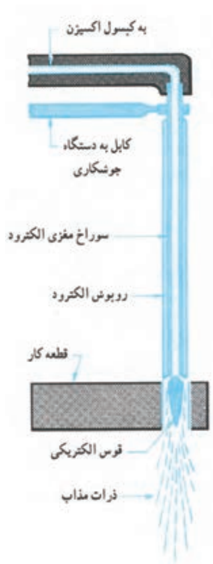
چگونگی برش قوسی با اکسیژن
