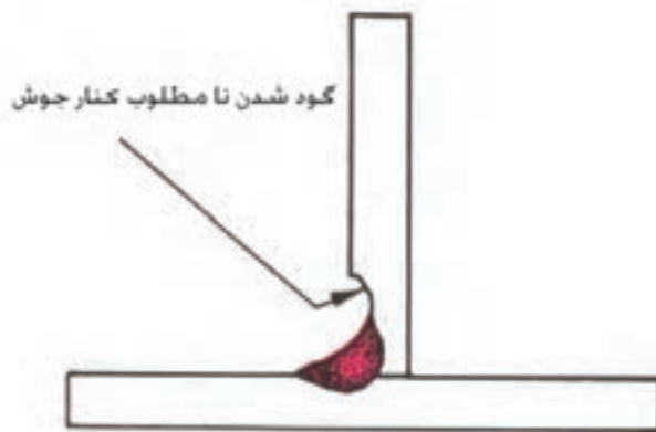
شکل ۸-۶۸ جوش سپری در حالتی که جوش دارای خوردگی است، نشان داده شده است
