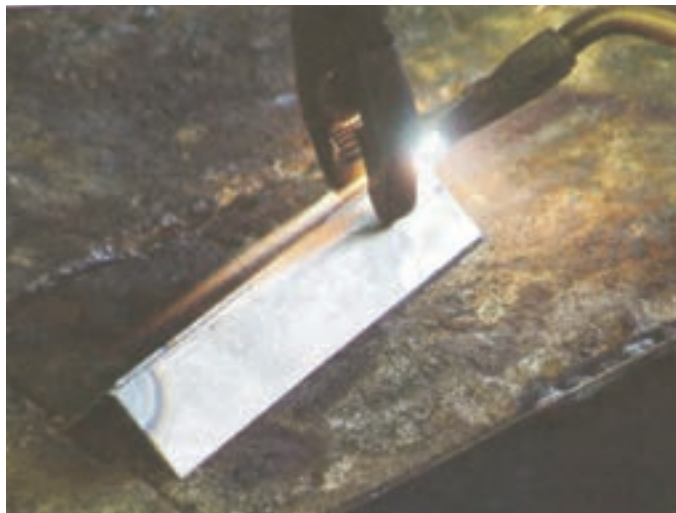
شکل ۸-۳۰ روش خال جوش زدن
