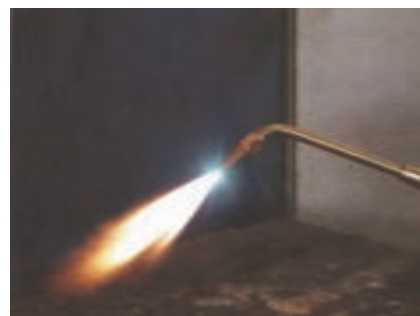
شکل ۲-۴ شعله‌ی سوختن گاز استیلن با اکسیژن
