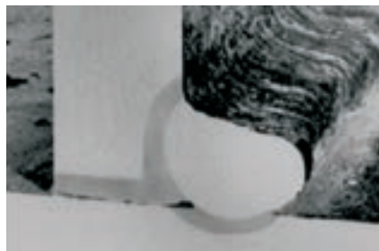
شکل ۴-۹ سررفتگی جوش ماهیچه‌ای
