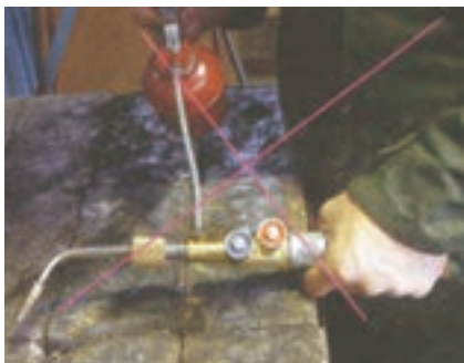
شکل ۳-۱۷ کار اشتباه روغن کاری مشعل
