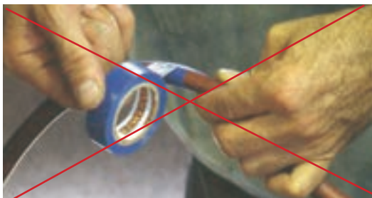
شکل ۱۳-۳ کار اشتباه تعمیر شیلنگ با چسب
