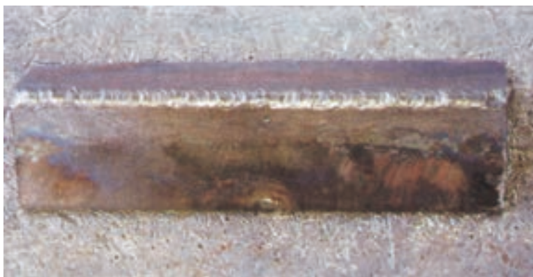
شکل ۸-۳۲ کار ذوب گوشه تمام شده
