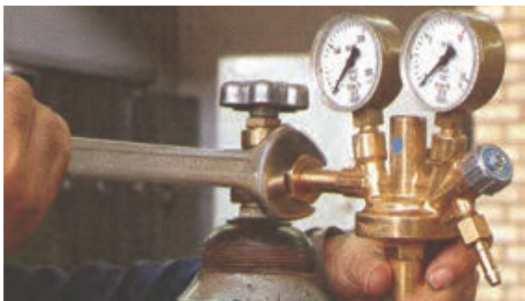
شکل ۵-۸ نحوه بستن رگولاتور کپسول اکسیژن
