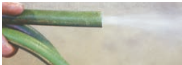
شکل ۱۴-۳ خروج پودر تالک از شیلنگ نو
