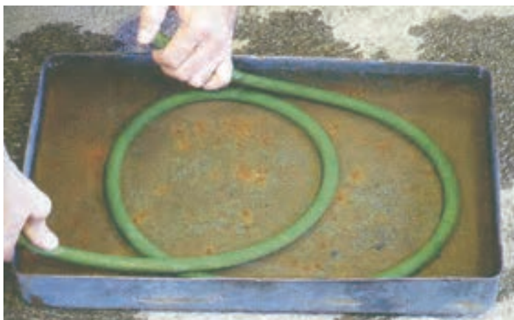
شکل ۸-۸-۱ کنترل سلامت شیلنگ‌ها
