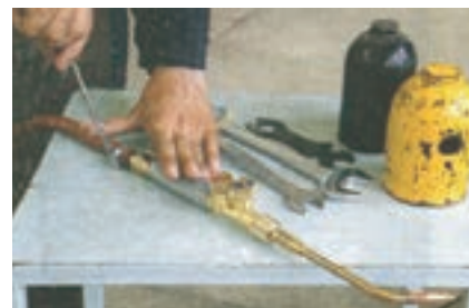
شکل ۷-۸ محل خروج اکسیژن از دسته مشعل
