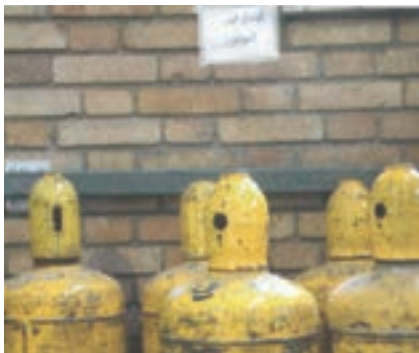
شکل ۳-۱۱ انبار کردن درست کپسول
