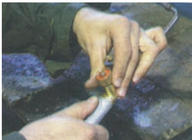
شکل ۸-۱۶ روش خاموش کردن شعله
