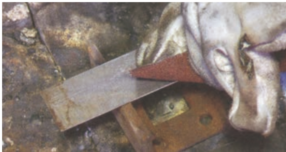
شکل ۲-۴ سنباده‌زنی سطح کار و درز کار و برس‌زنی کار قبل از جوشکاری
