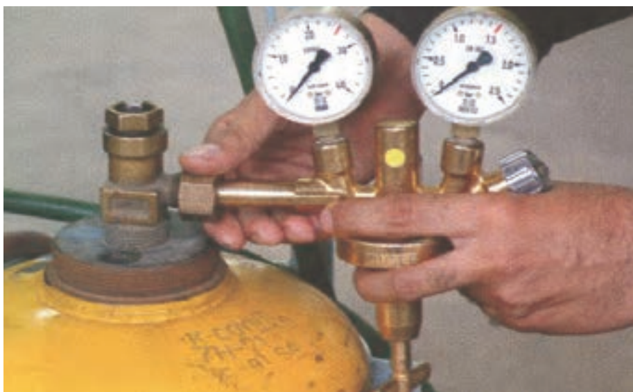
شکل ۱-۲۲-۲ بستن رگولاتور به کپسول
