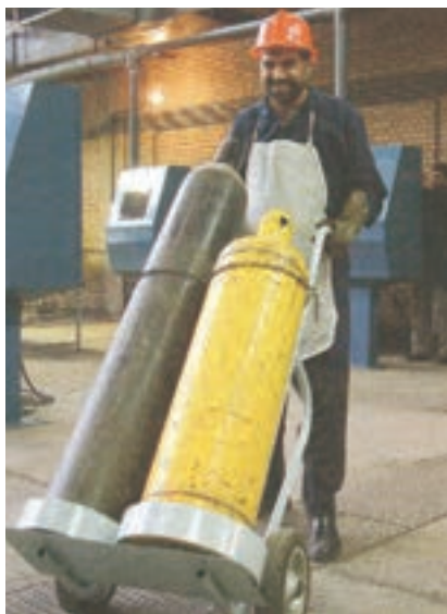
شکل ۸-۲ نحوه بستن و حمل کپسول‌ها
