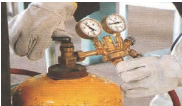
شکل ۱۰-۸ نحوه باز کردن شیر فلکه کپسول استیلن
