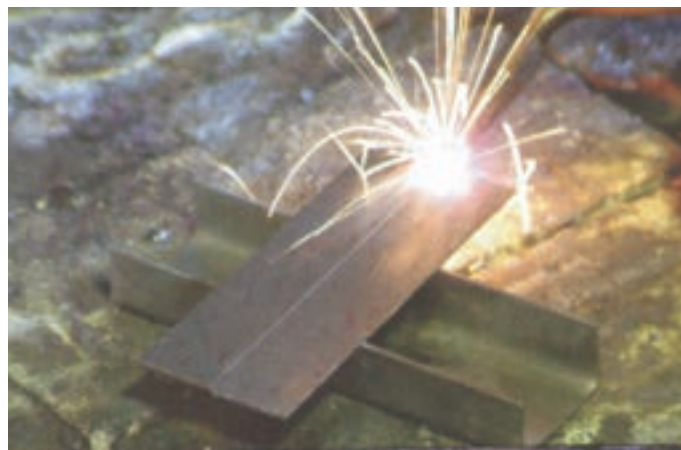
شکل ۸-۴۸ خال جوش زدن در طرفین اتصال
