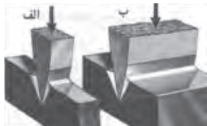
شکل ۱۸-۲ شکل نفوذ گوه در فولاد
