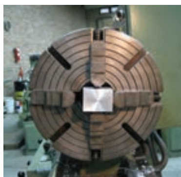
شکل ۲-۱۰ بستن قطعه کار با مقطع مستطیل شکل
