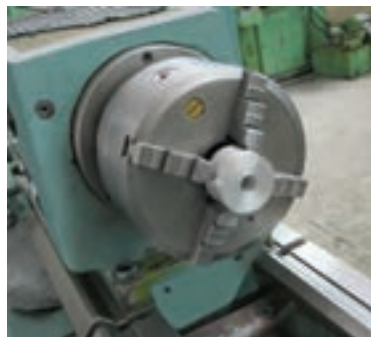
شکل ۲-۸ بستن قطعه کار با مقطع گرد
