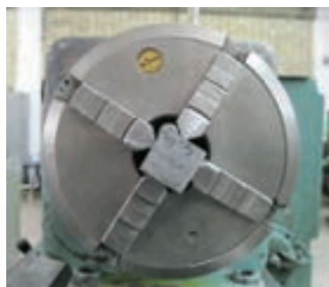
شکل ۲-۷ بستن قطعه کار با مقطع چهارگوش
