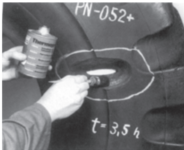
شکل ۶-۶-۱۶- چسب زدن محدوددهی حفره‌ی ترکیبگی
