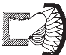
شکل ۲-۹- مکانیزم متحرک زنجیر و نحوه ایجاد شیار
