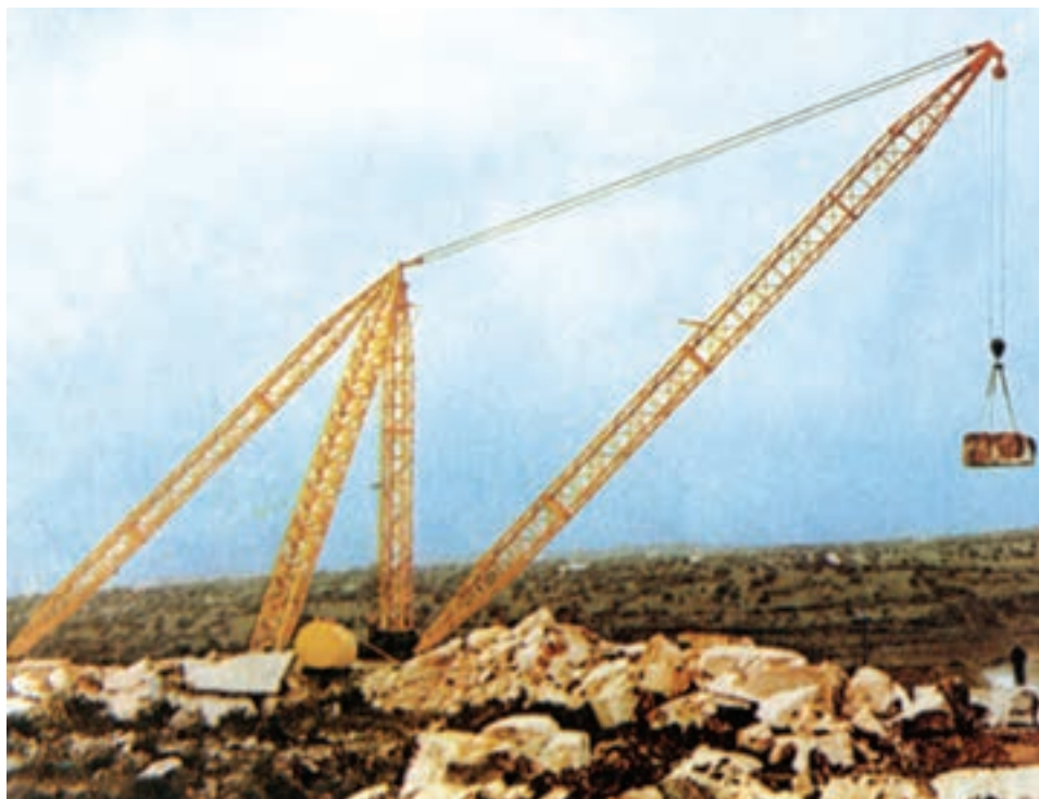
شکل ۲۲-۵- جرثقیل مخصوص حمل بلوک‌های سنگ استخراجی
