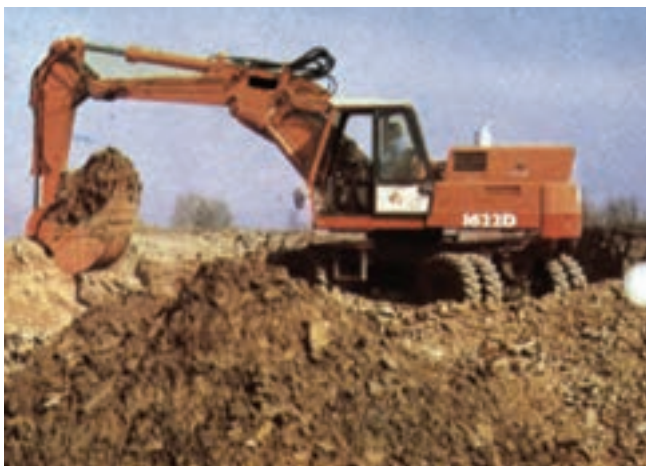
شکل ۲۰-۴- بیل مکانیکی چرخ لاستیکی با جام معکوس
