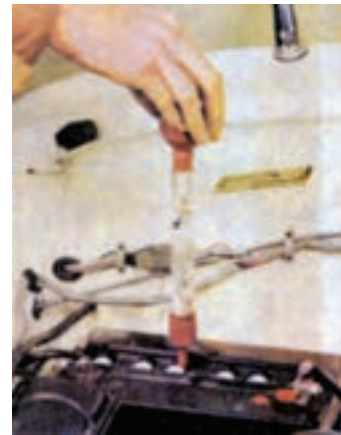
شکل ۵-۱۱- با هیدرومتر می‌توان شارژ بودن باتری را آزمایش نمود. هرگاه باتری شارژ باشد آب اسید آن غلظت بیش‌تری را نشان می‌دهد.
