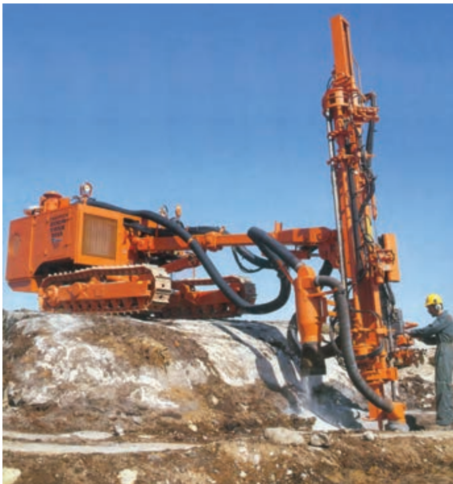
شکل ۲-۲۳- واگن دریل در حال چال زدن
