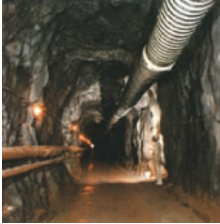
شکل ۳۲-۲- کاربرد لوله‌های تهویه
