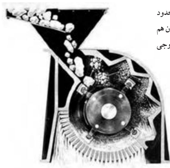
طرز کار سنگ شکن چکشی
