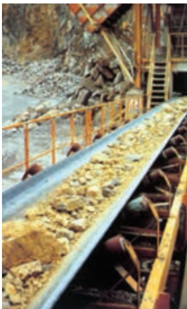
شکل ۱۷-۱- نوار نقاله در حال انتقال مواد معدنی
