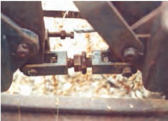
شکل ۲-۳۲- نحوه‌ی عملکرد ترمز لوکوموتیو
