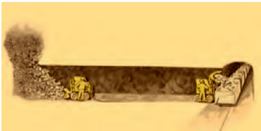
شکل ۶-۳- مراحل کارکرد لودر تونلی (خاک بر سر)
