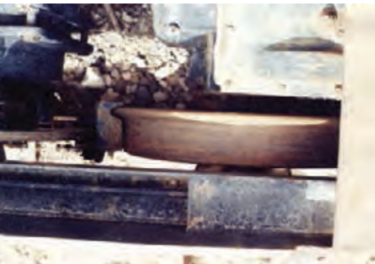
شکل ۳-۳۲- نحوه‌ی عملکرد کفشک‌های ترمز بر روی چرخ
