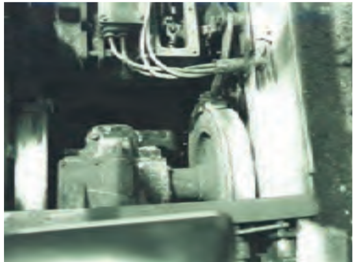
شکل ۱۱-۳۲- چرخ‌های لوکوموتیو و کفشک‌های ترمز آن
