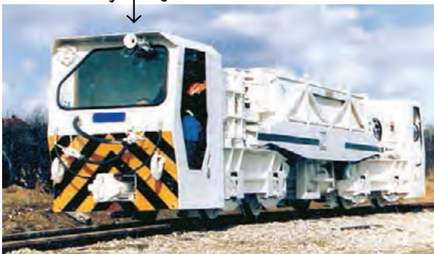
شکل ۳۲-۶- لوکوموتیو معدنی قسمت علامت‌دار زنگ خطر
