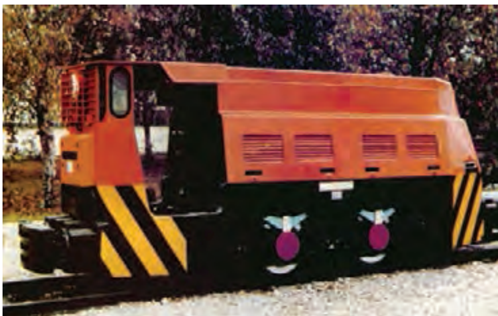
شکل ۸-۳۲- سپر ثابت فولادی و فنردار یا لاستیکی
