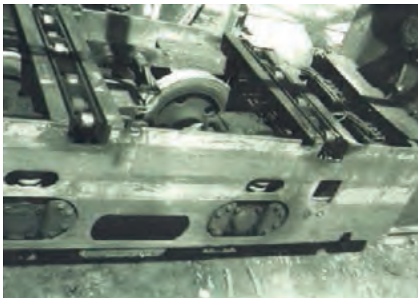
شکل ۹-۳۲- غلتک‌های زیر جعبه‌ی باتری
