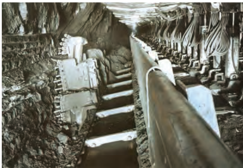
شکل ۵-۲۷- پایه‌ی هیدرولیکی و متحرک
