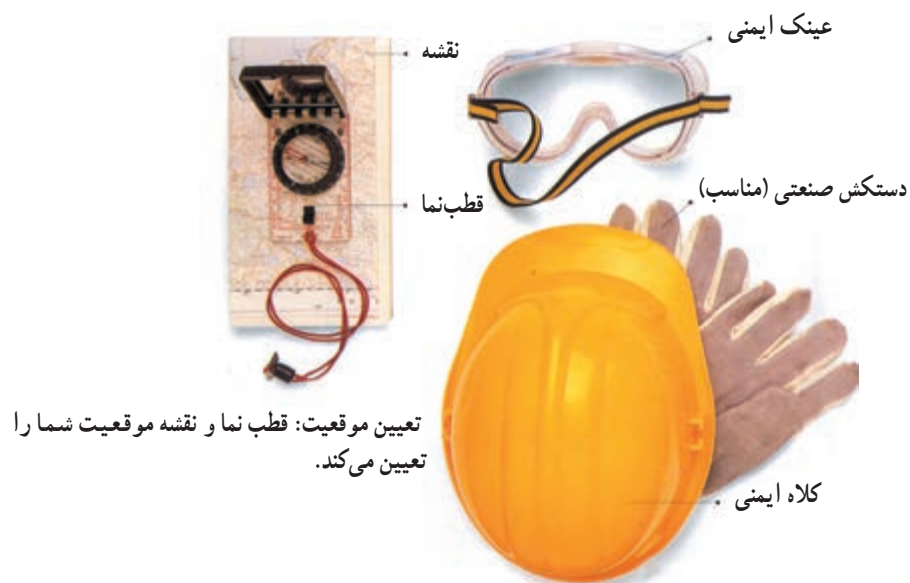
شکل ۲-۷- تجهیزات عملیات صحرائی و وسایل ایمنی
