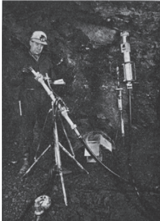
شکل ۶-۸- خرج گذاری در معدن زیر زمینی با دستگاه خرج گذار هوای فشرده
