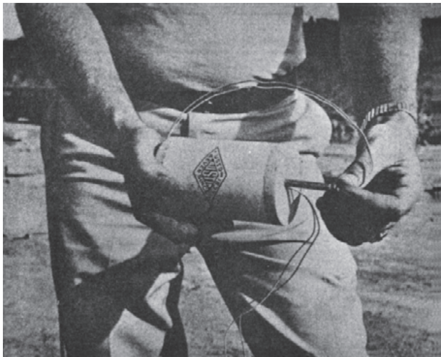
شکل ۸-۱۱ - قرار دادن چاشنی برقی در پرایمر
