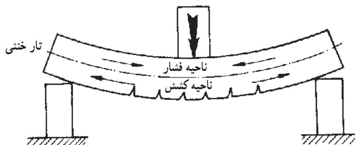
شکل ۶-۲۱- تیر بتنی پس از بارگذاری
