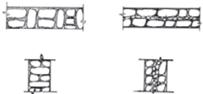
شکل ۸-۲۰- نمای دیوار خشکه چینی بدون ملات
