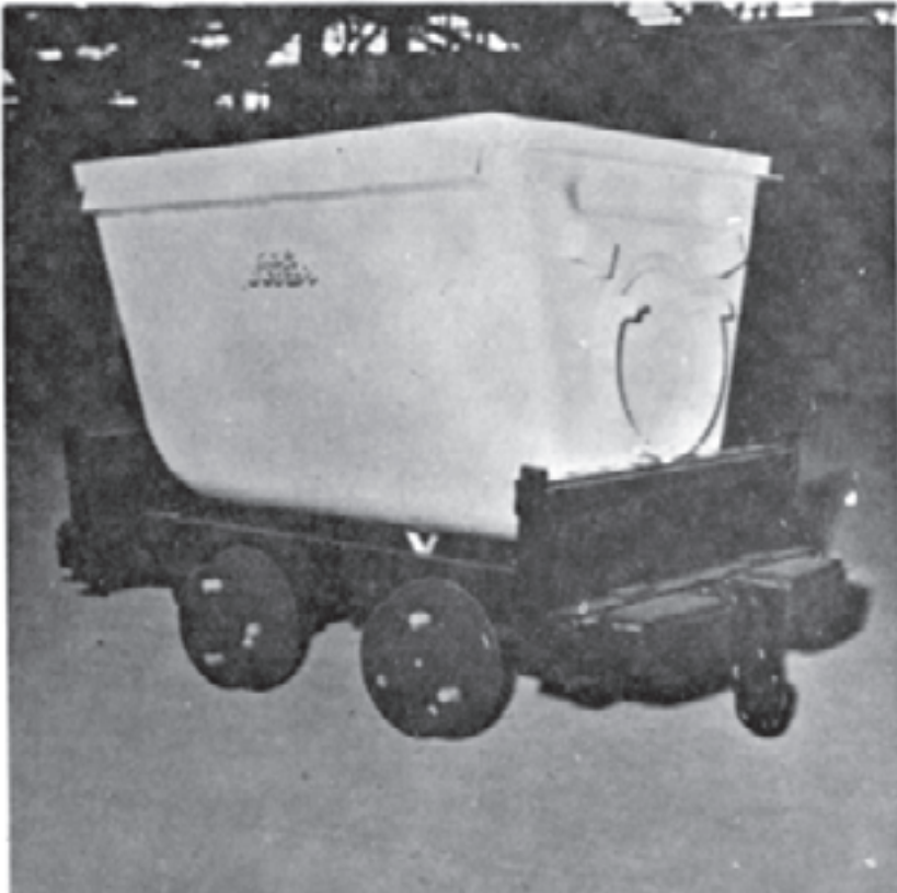
شکل ۱۲-۱۹- نمای ظاهری و مشخصات یک واگن معدنی ساخت کارخانه ماشین سازی اراک مطابق شکل ۱۲-۱۸، مهمترین قسمت‌های یک واگن صندوقه (۱)، شاسی و ضربه گیر (۲)، چرخ و محور (۳) و وسیله اتصال (۴) است که در زیر به شرح آنها می‌پردازیم.
