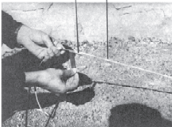
شکل ۱۶-۱۶- نحوه‌ی اتصال چاشنی به فتیله با نوار چسب
