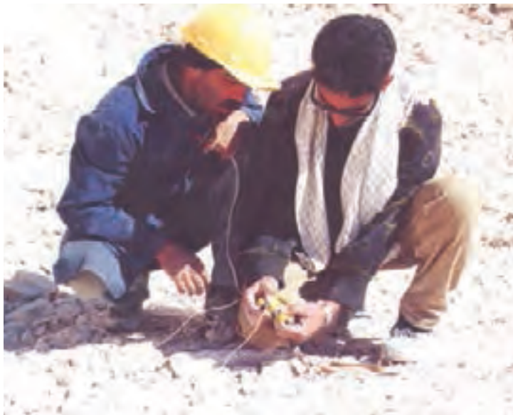
شکل ۱۲- ۱۶- نحوه‌ی کارکردن با اهم متر
