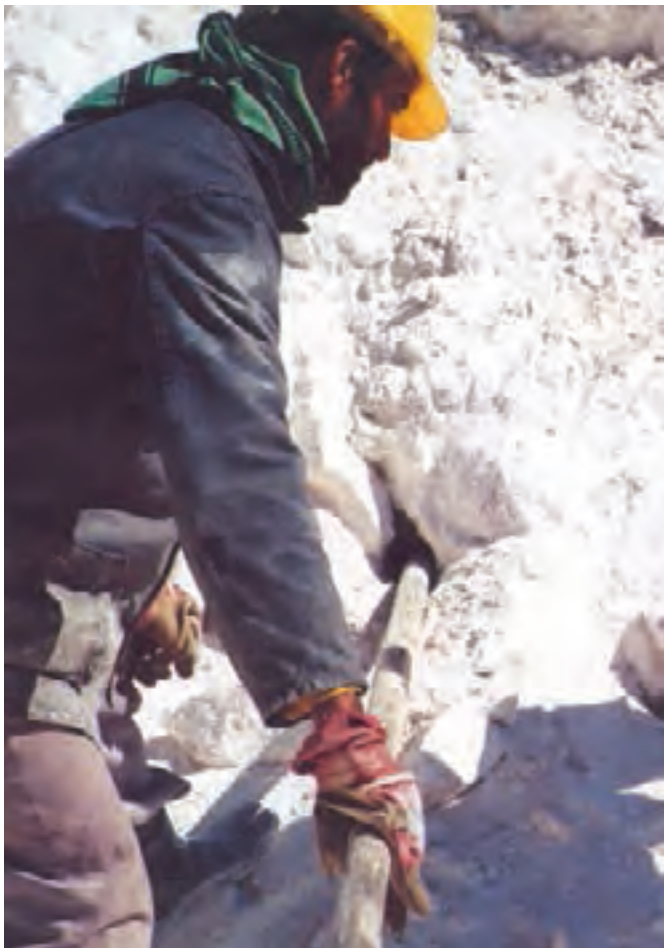
شکل ۳-۱۶- مراحل کار با سنبه چوبی
