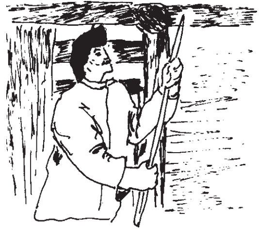
شکل ۳-۱۷- بازرسی سقف و داربست از طریق صدا
