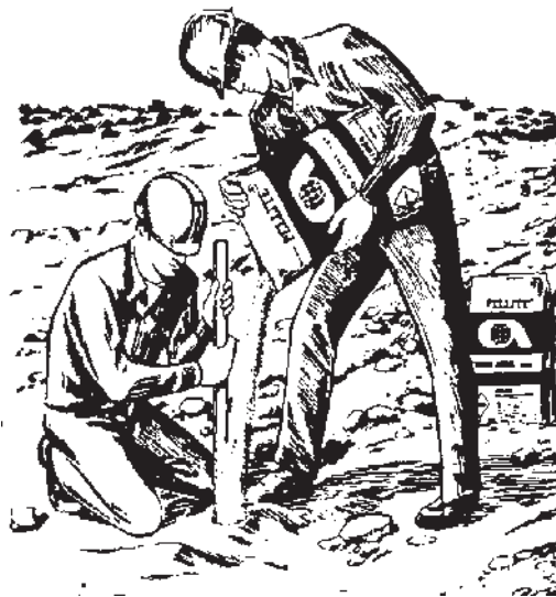
شکل ۷-۴- فشردن آنفو در چال با سنبه چوبی
