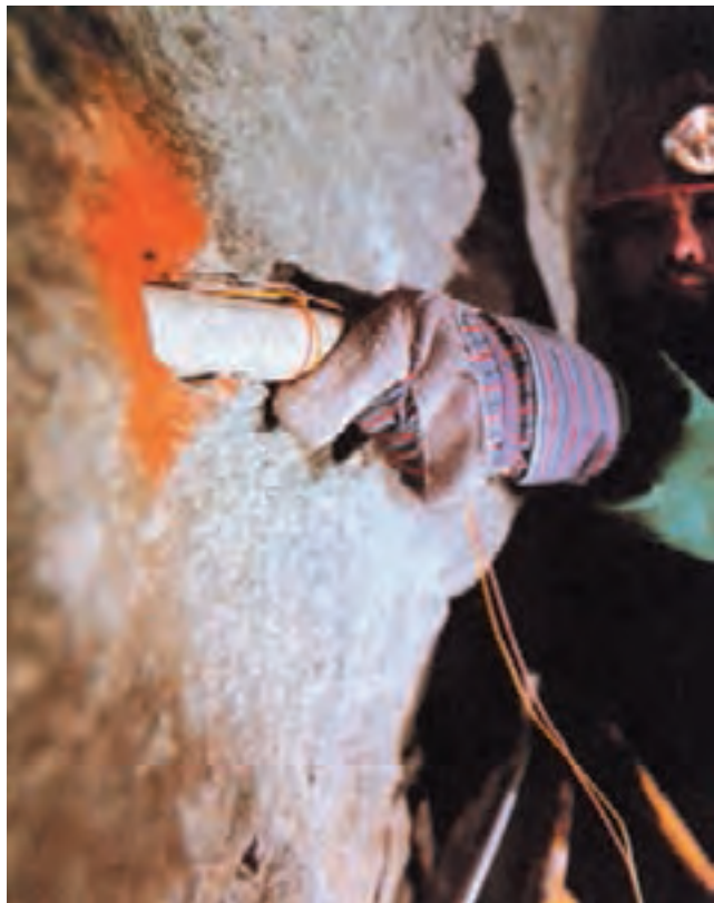
شکل ۴۱-۷- قرار دادن فشنگ چاشنی‌دار در چال
