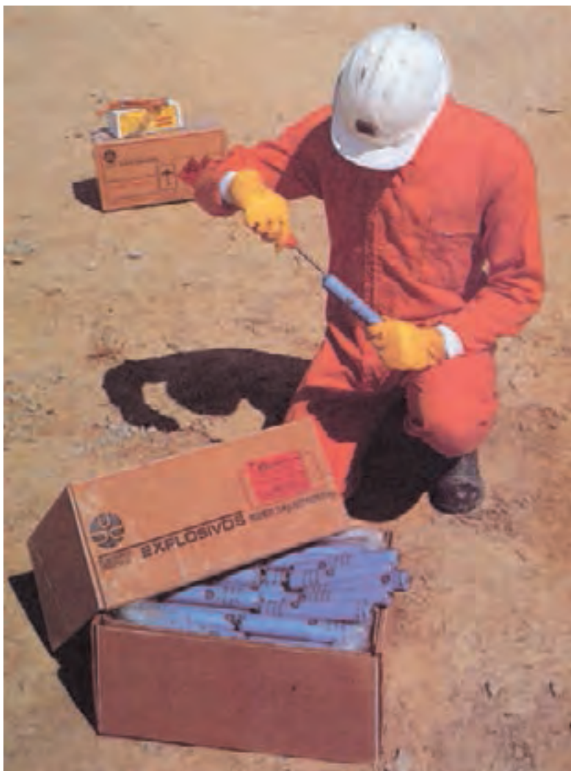
شکل ۷-۱۳- سوراخ کردن دینامیت با درفش
