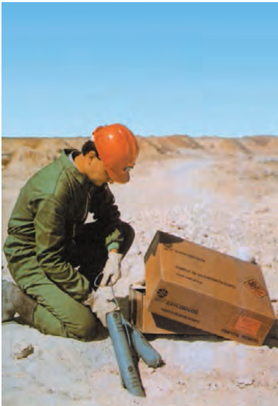
شکل ۷-۳۲- خرج‌گذاری دینامیت سنگین وزن با فتیله انفجاری
