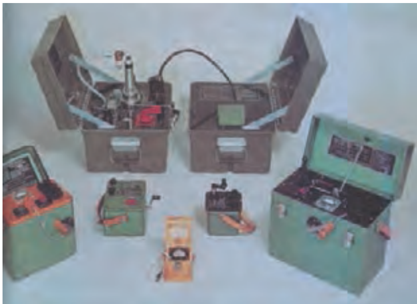
شکل ۷-۴۶- چند نوع ماشین آتش کن برقی ۱ ساخت نیترو نوبل
