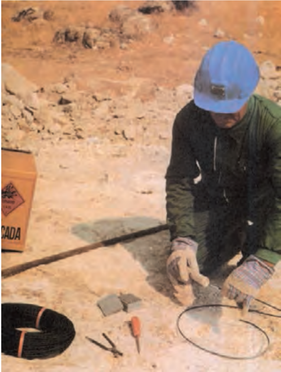
شکل ۸-۷- اجزای آتشکاری با فتیله اطمینان شامل : چاشنی، فتیله اطمینان، دینامیت، گاز انبر، سنبه چوبی و درفش
