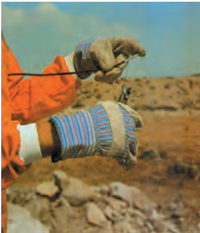
شکل ۱۲-۷- طریقه به دست گرفتن چاشنی و انبردست مخصوص
