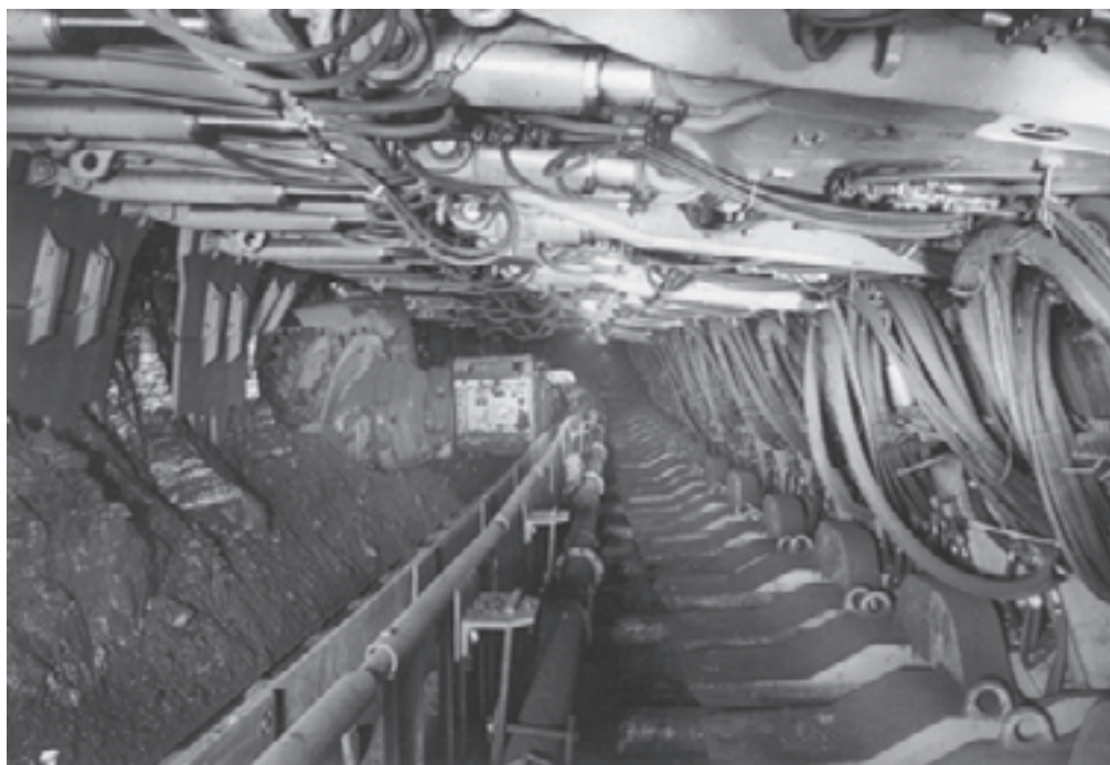
شکل ۹-۲۰- پایه قدرتی در کارگاه استخراج
