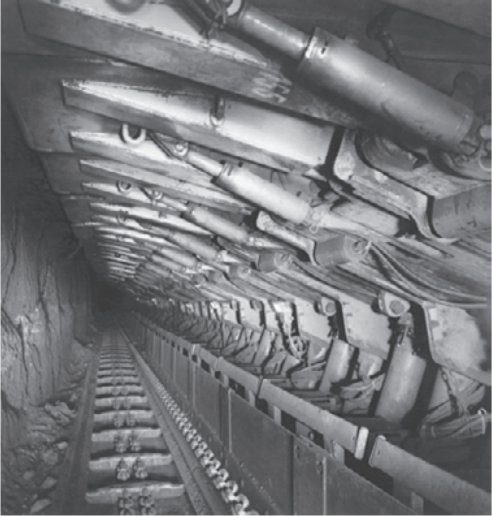
شکل ۹-۱۹- پایه قدرتی در کارگاه استخراج
