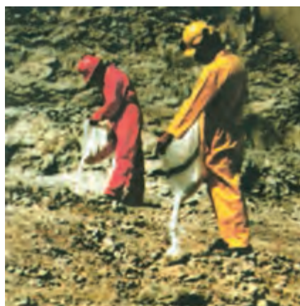
شکل ۳۶-۶- نحوه پرکردن پودر آذر و آنفو در چال‌های انفجاری با بسته‌بندی کیسه‌ای
