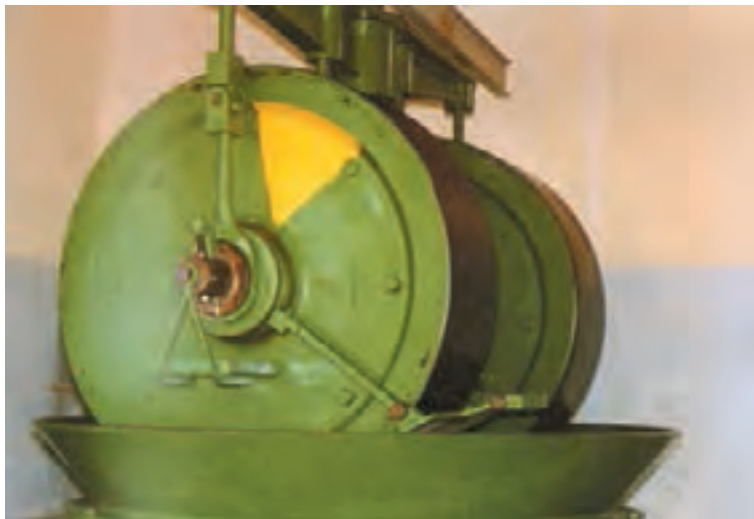
شکل ۴۵-۶- سنگ شکن جهت خرد کردن باروت
